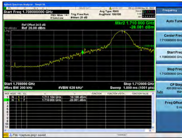
Band66 / 20MHz / High CH / QPSK / 1 RB
