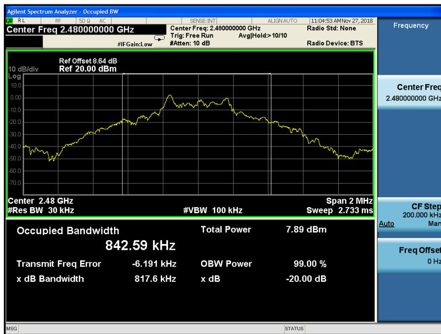
Test Mode:  $\pi/4$ DQPSK
