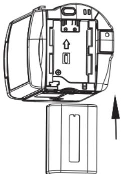
1.将电池按此方向装入电池槽
