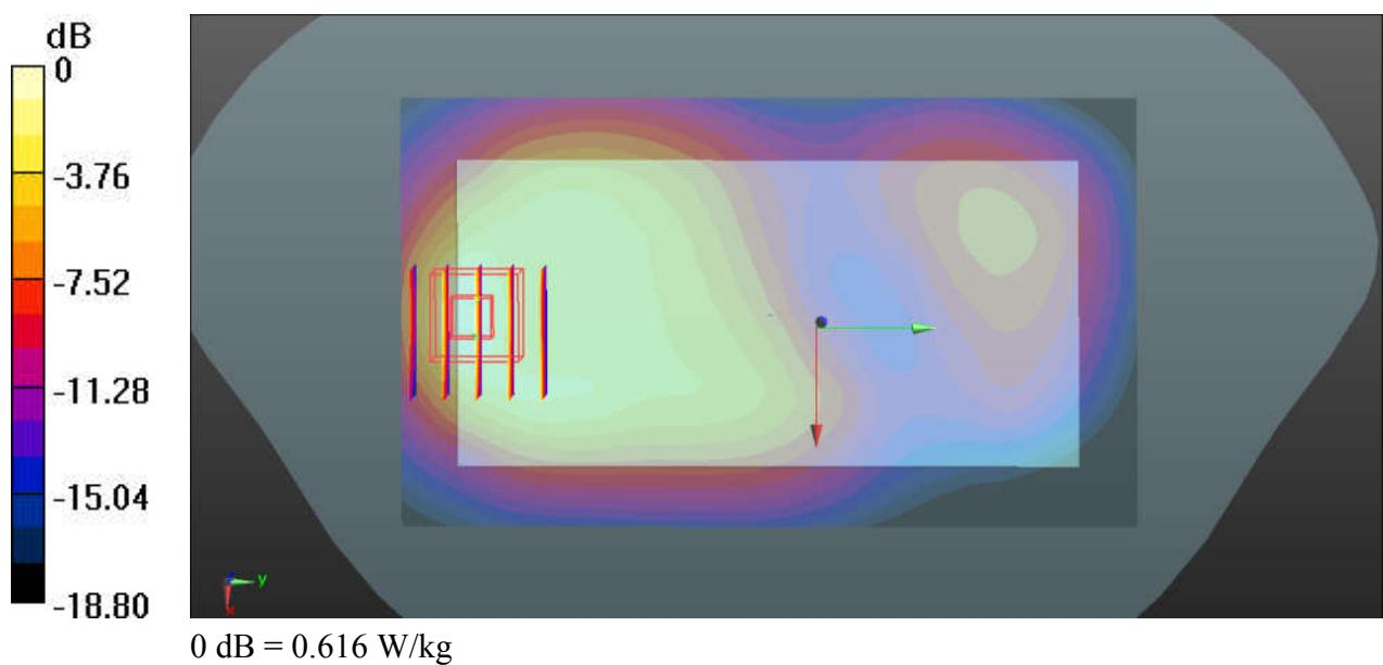
**14\_LTE Band 2\_20M\_QPSK\_1RB\_0Offset\_Back\_10mm\_Ch19100**
