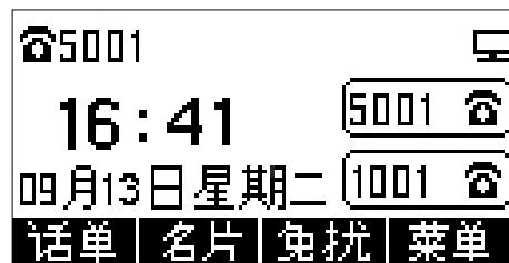
**注：**若电话屏幕没有显示以上信息，请确认是否安装正确。确认后若话机仍然无法正常启动可尝试拔下电源插头并再次插入。若您仍然看不到显示，请联系您的电话管理员或服务提供商。
