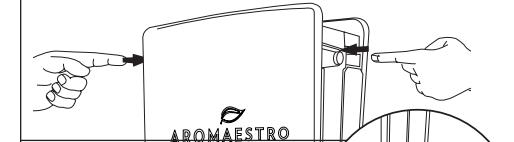
Presser à l'endroit indiqué pour ouvrir la porte. Brancher le câble d'alimentation dans le connecteur du diffuseur et brancher le transformateur dans une prise électrique.
