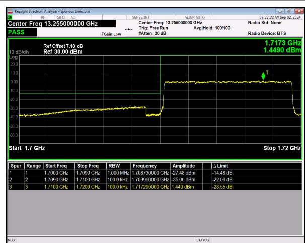
n66 SCS=15kHz DFT_64QAM BW=10MHz LowChannel=343000 RB=50@0 NVNT
