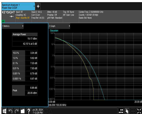
n41 SCS=30kHz DFT_256QAM BW=20MHz Channel=518598 RB=50@0 NVNT
