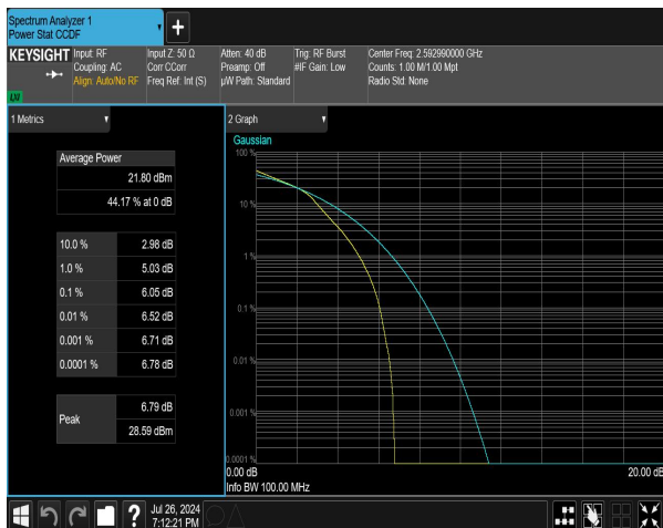
n41 SCS=30kHz DFT_16QAM BW=20MHz Channel=518598 RB=50@0 NVNT
