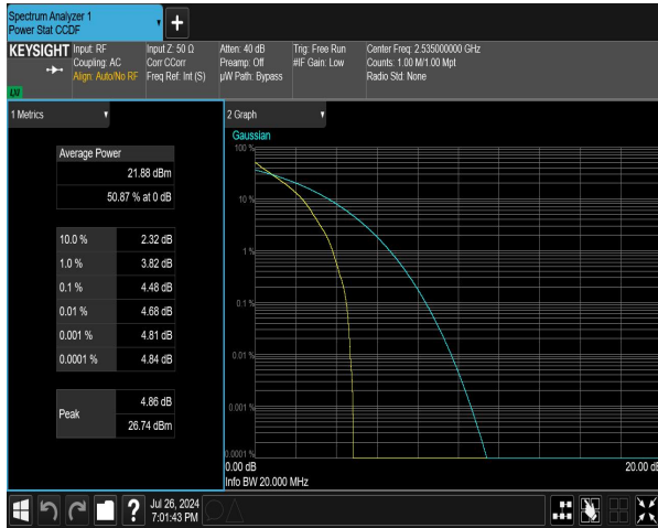
n7 SCS=15kHz DFT_QPSK BW=10MHz Channel=507000 RB=50@0 NVNT
