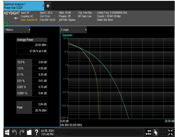
n7 SCS=15kHz DFT_16QAM BW=10MHz Channel=507000 RB=50@0 NVNT
