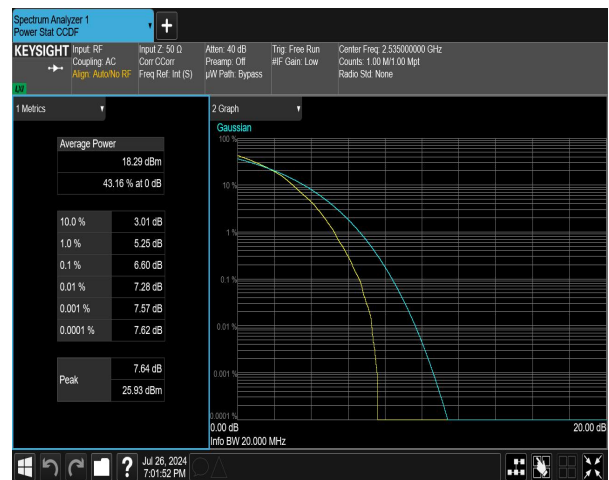
n7 SCS=15kHz DFT_256QAM BW=10MHz Channel=507000 RB=50@0 NVNT
