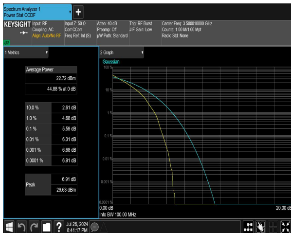
n77(3450-3550) SCS=30kHz DFT_QPSK BW=80MHz
