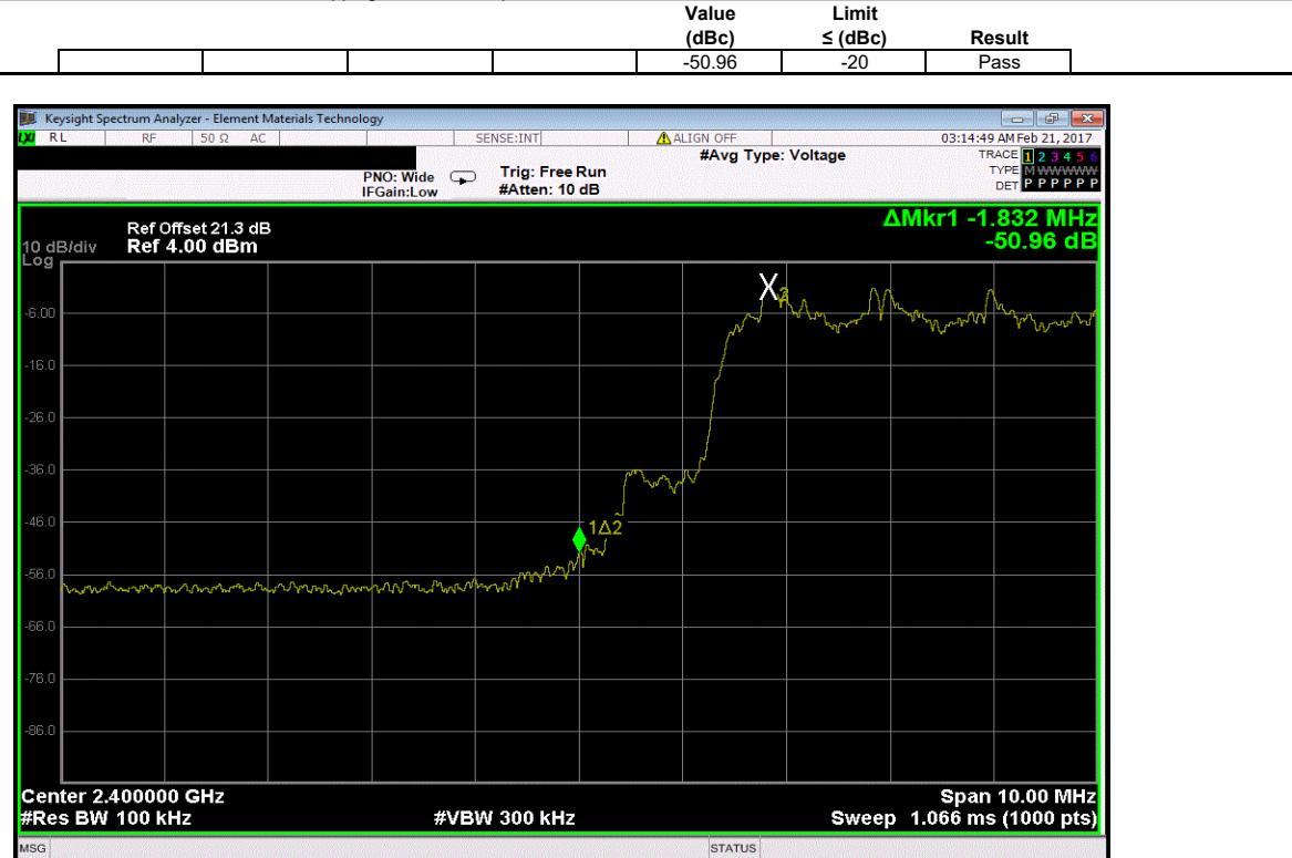
Hopping Mode, 2DH5, pi/4-DQPSK, High Channel, 2480 MHz
