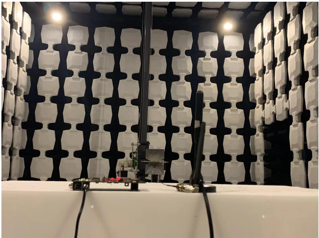
A7672SA miniPCIE RSE 3GHz-18GHz
