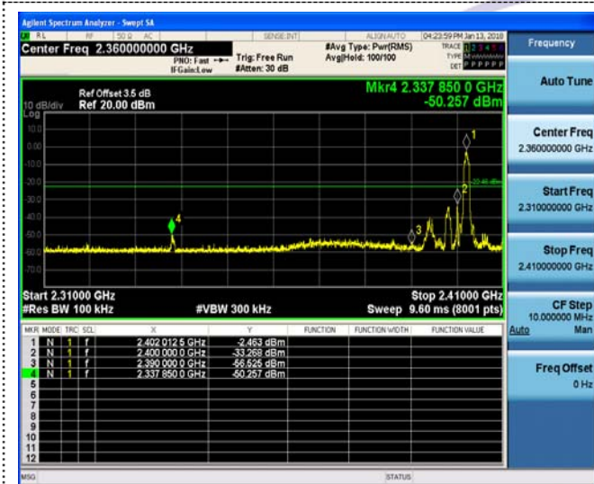
Left Band edge hopping off
