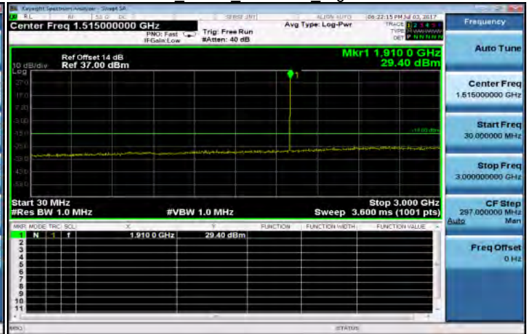
30MHz~3GHz EDGE 1900MHz HighCH810-1909.8
