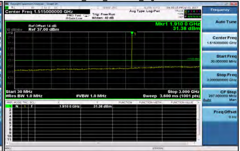
30MHz~3GHz GSM 1900MHz HighCH810-1909.8
