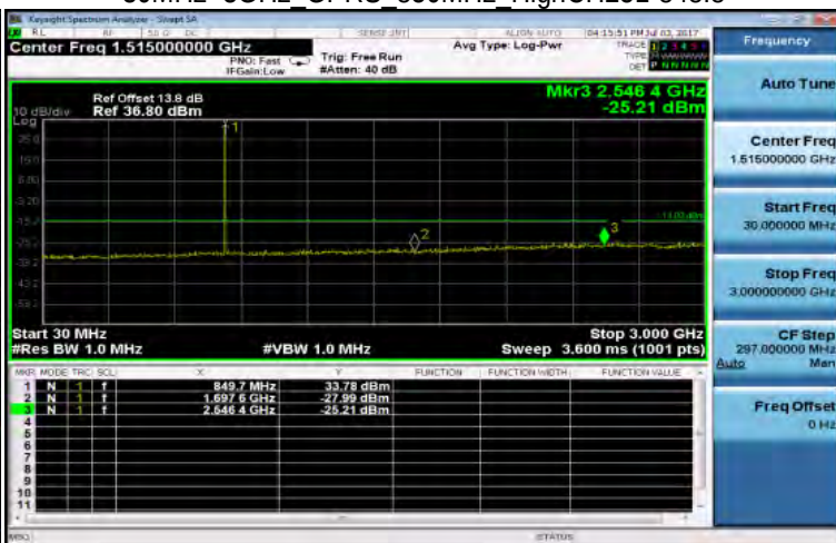
30MHz~3GHz GPRS 850MHz HighCH251-848.8
