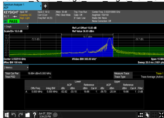
B2_N48(5M)_DFT-s- OFDM QPSK Edge 1RB Right Low CH
