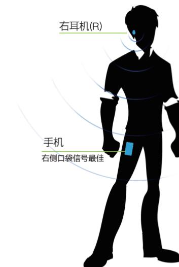
右耳机负责接收手机蓝牙信号，建议将手机放在右侧口袋，这样可避免人体隔断信号，提升户外使用时的抗干扰能力。
