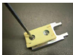
Schraube mit W.6 lösen remove the screws with W.6
