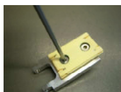
Schraube mit W.6 lösen remove the screws with W.6
