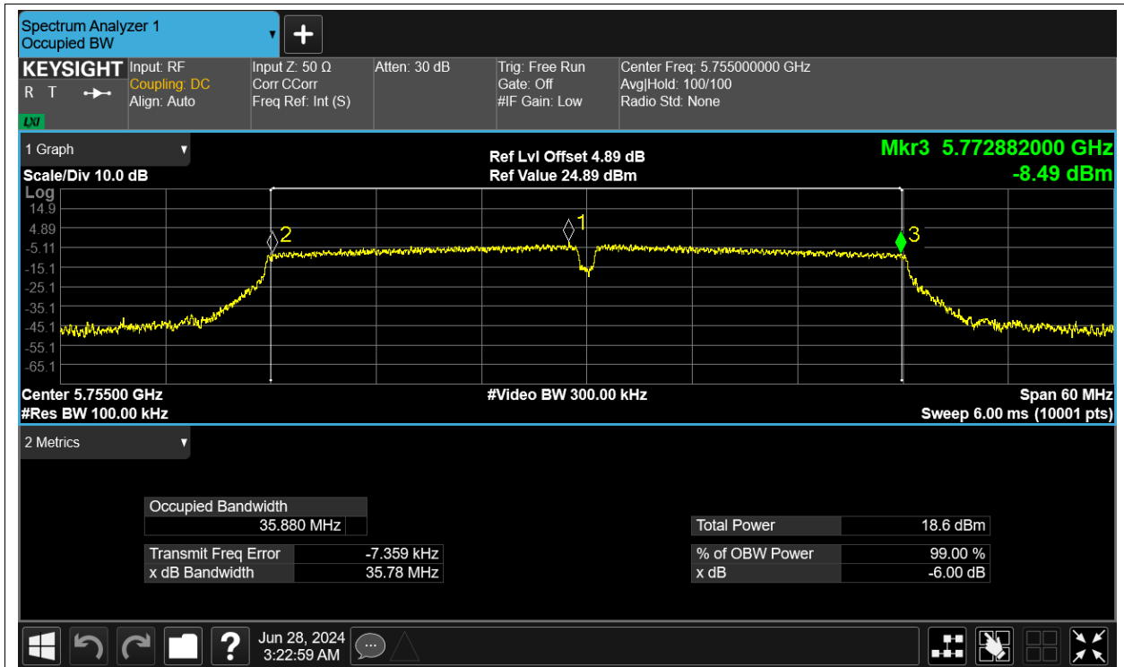
-6dB Bandwidth NVNT n40 5795MHz Ant1
