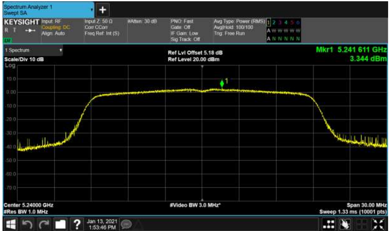
PSD NVNT n40 5190MHz Ant1
