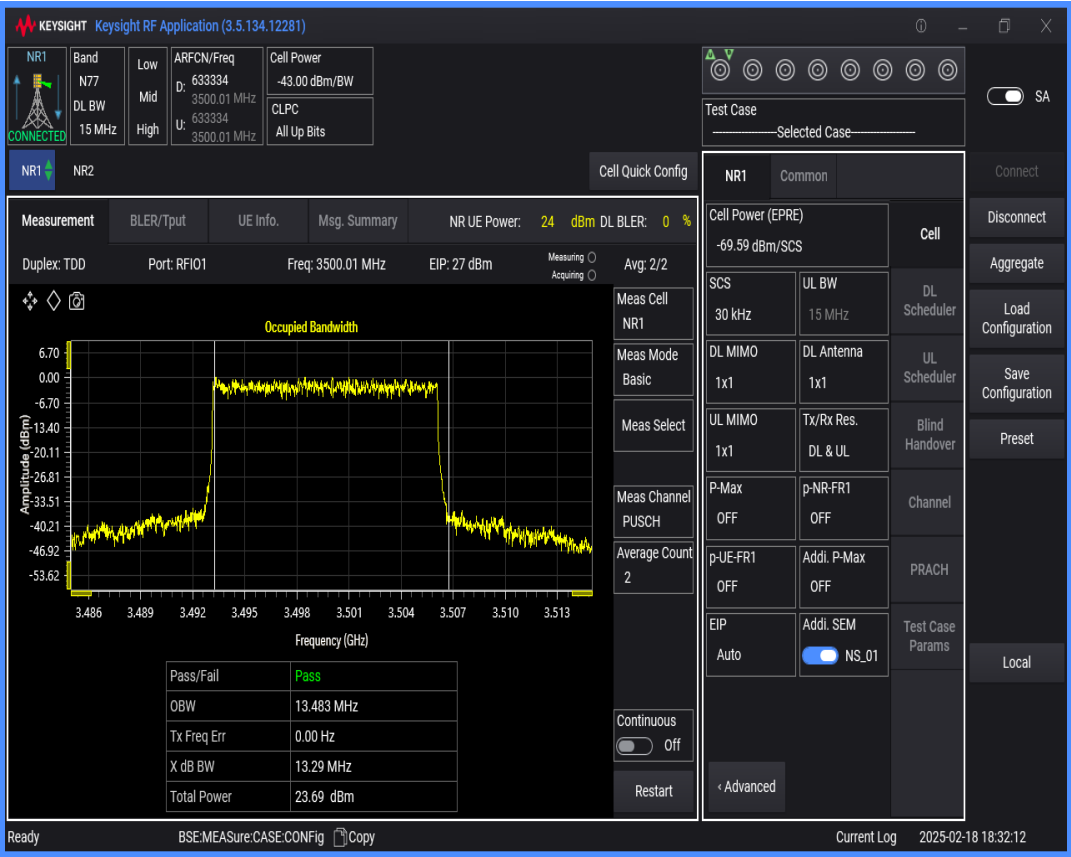
n77(3450-3550) SCS=30kHz DFT_QPSK BW=20MHz Channel=633334 RB=50@0
