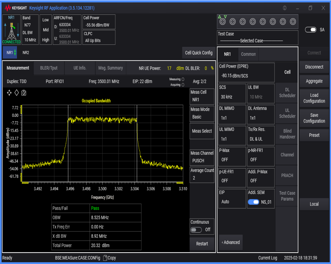
n77(3450-3550) SCS=30kHz DFT_QAM256 BW=20MHz Channel=633334 RB=50@0
