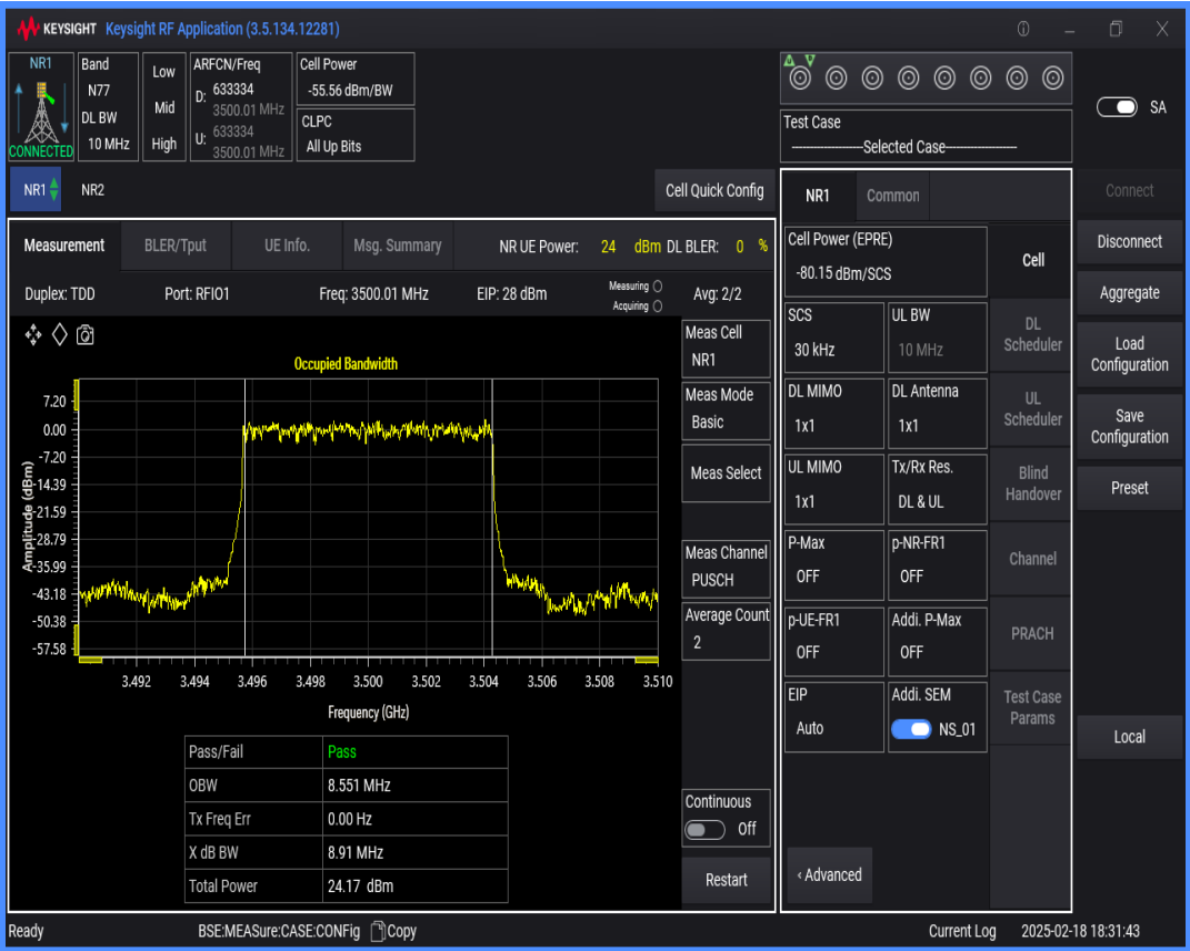
n77(3450-3550) SCS=30kHz DFT_BPSK BW=20MHz Channel=633334 RB=50@0
