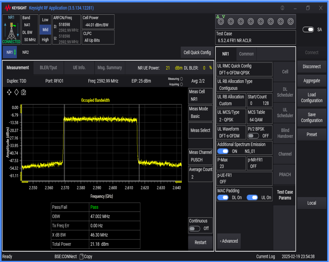
n41 SCS=30kHz DFT_QPSK BW=40MHz Channel=518598 RB=100@0
