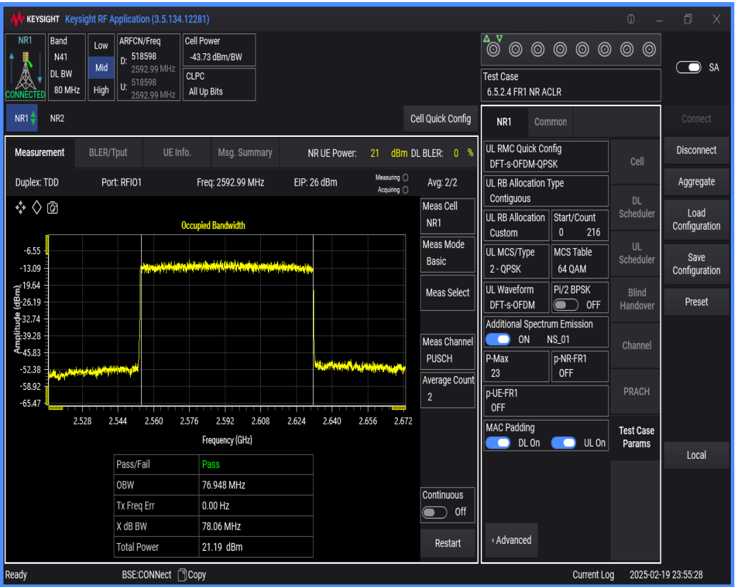
n41 SCS=30kHz DFT_QPSK BW=90MHz Channel=518598 RB=240@0
