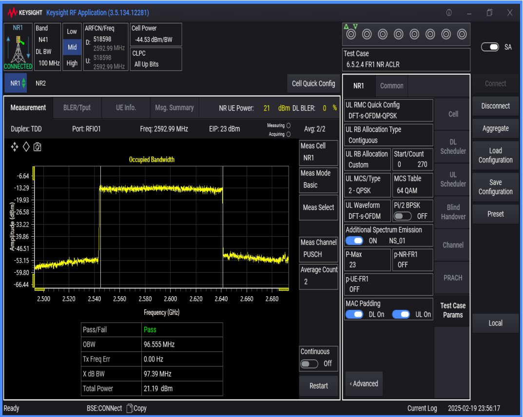
n41 SCS=30kHz DFT_QPSK BW=20MHz Channel=518598 RB=50@0
