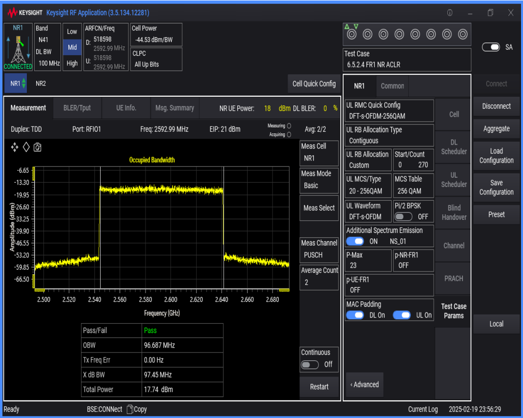
n41 SCS=30kHz DFT_QAM256 BW=20MHz Channel=518598 RB=50@0
