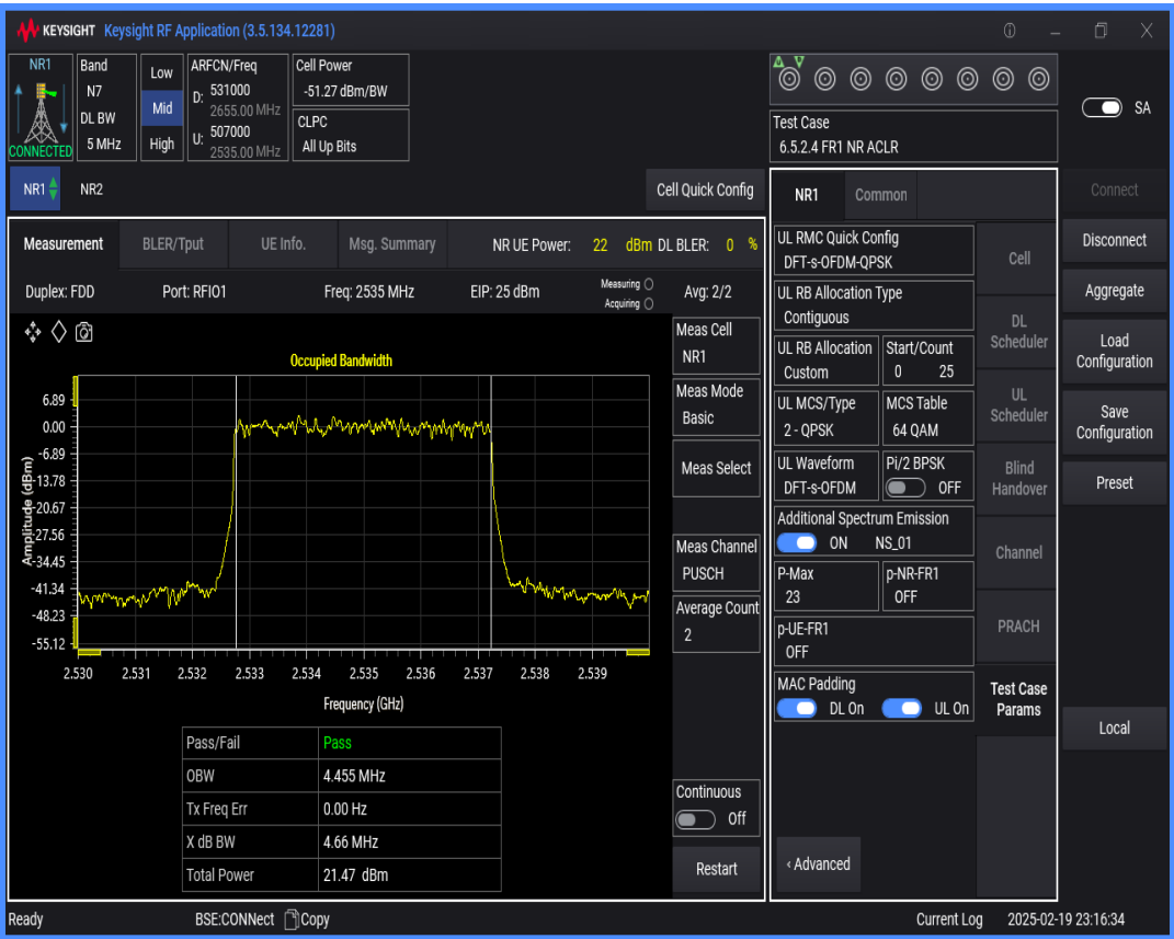
n7 SCS=15kHz DFT_QPSK BW=5MHz Channel=507000 RB=25@0
