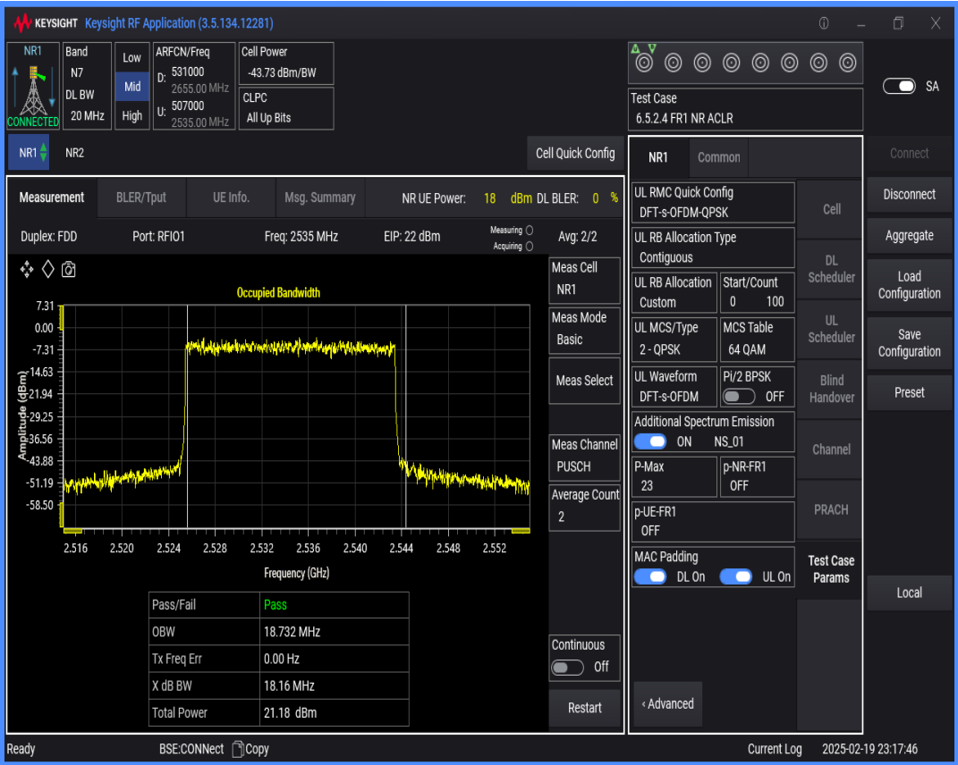
n7 SCS=15kHz DFT_QPSK BW=5MHz Channel=507000 RB=25@0
