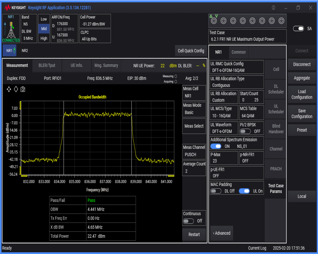
n5 SCS=15kHz DFT_QAM256 BW=10MHz Channel=167300 RB=50@0
