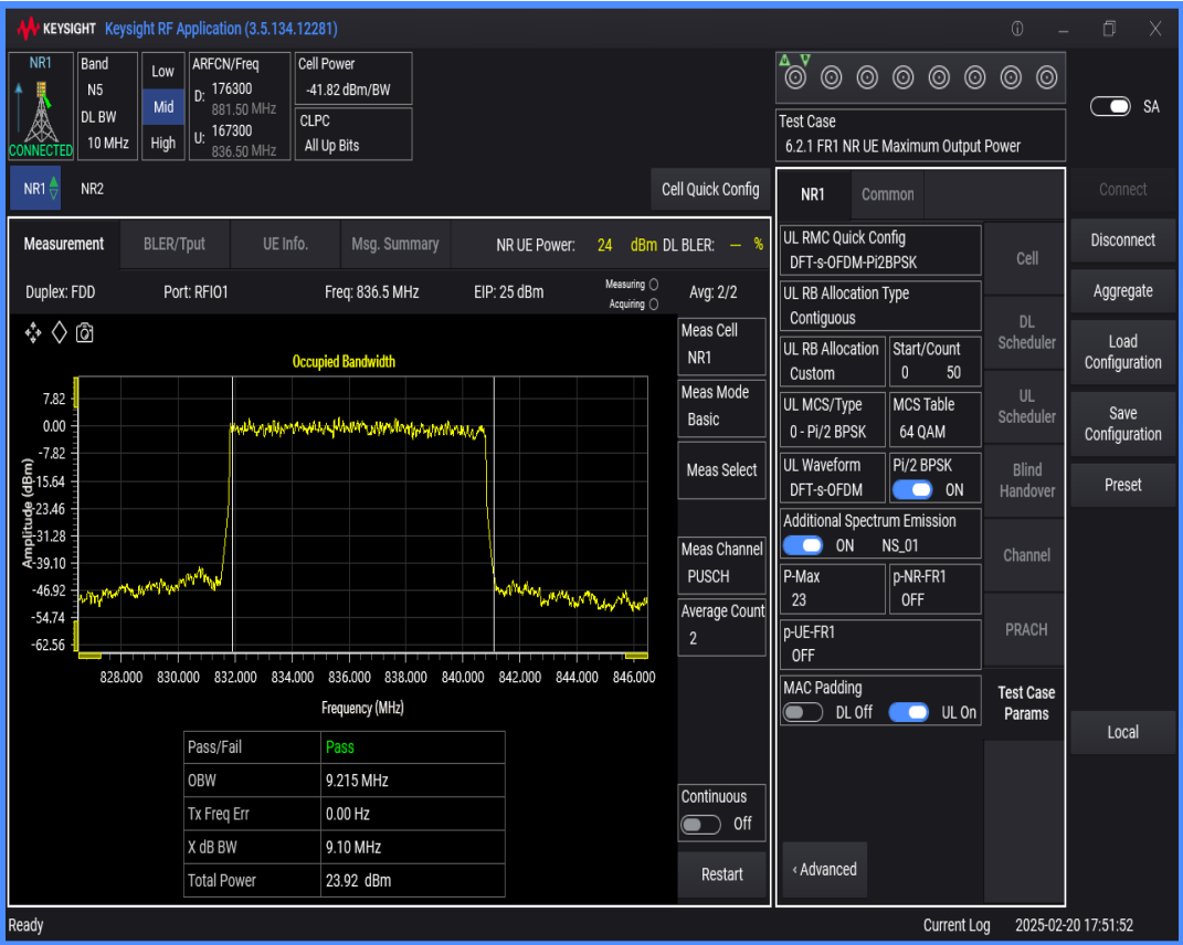
n5 SCS=15kHz DFT_BPSK BW=15MHz Channel=167300 RB=75@0
