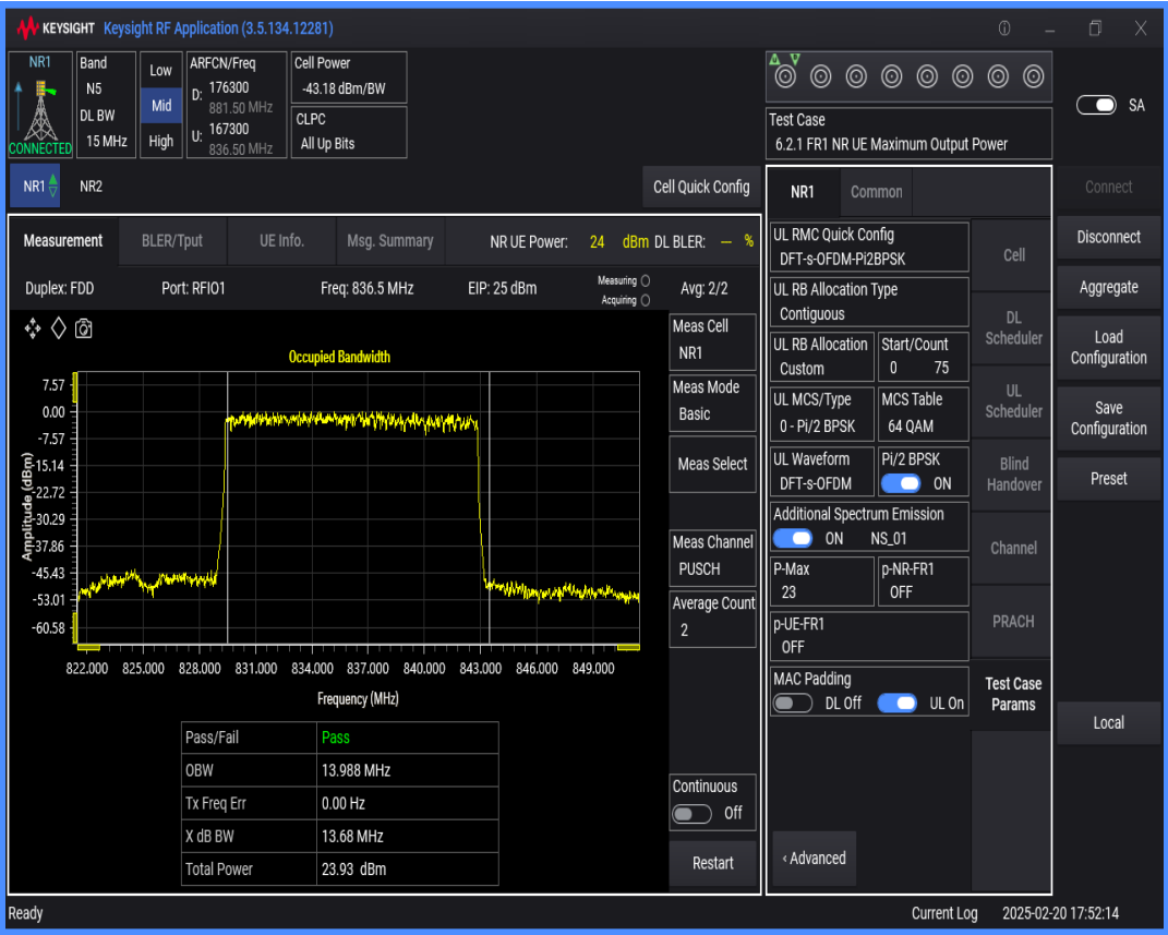
n5 SCS=15kHz DFT_BPSK BW=20MHz Channel=167300 RB=100@0
