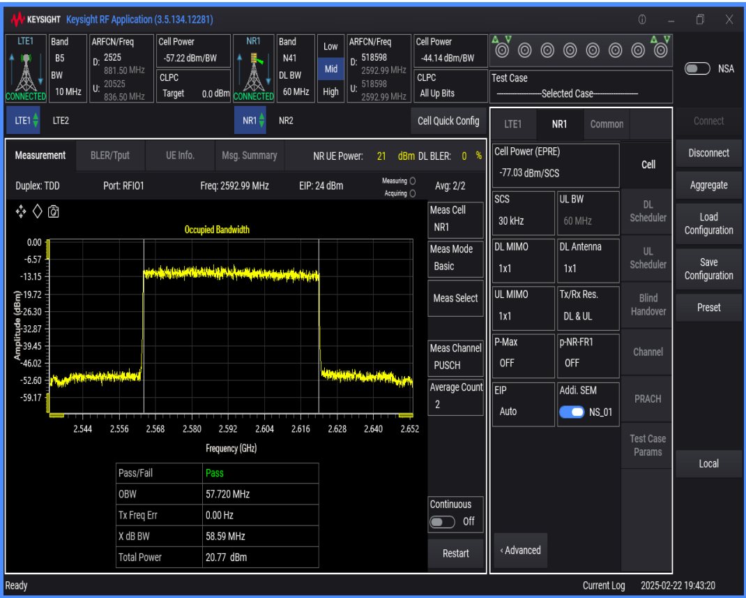
n41 SCS=30kHz DFT_QPSK BW=20MHz Channel=518598 RB=50@0
