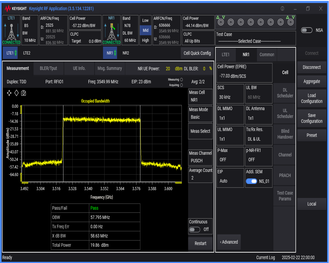
n78 SCS=30kHz DFT_QAM64 BW=20MHz Channel=636666 RB=50@0
