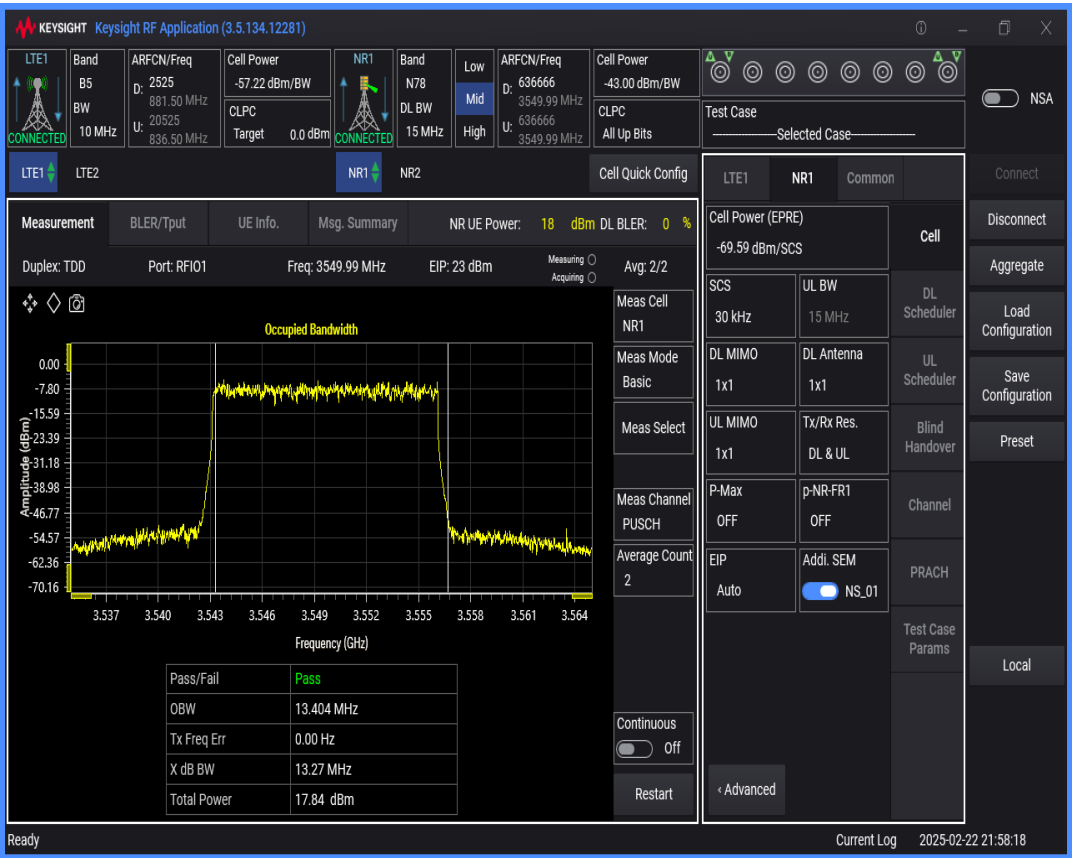
n78 SCS=30kHz DFT_QAM256 BW=20MHz Channel=636666 RB=50@0
