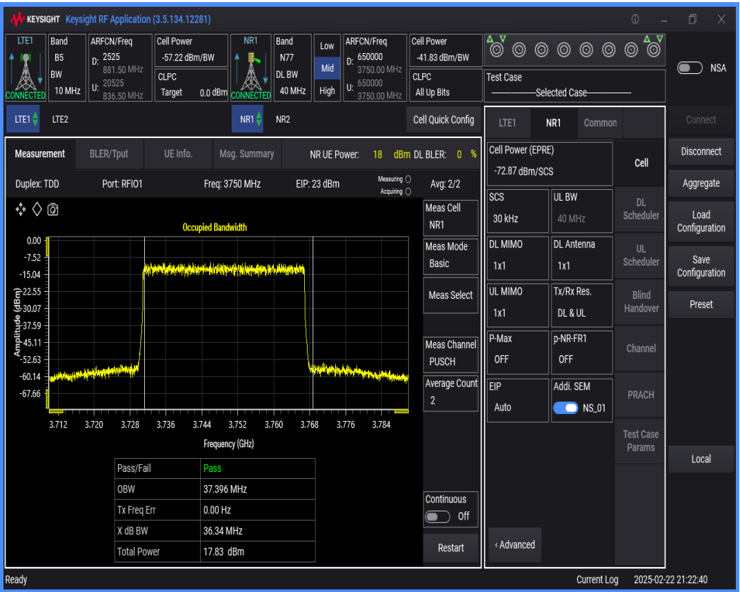
n77 SCS=30kHz DFT_QAM256 BW=20MHz Channel=650000 RB=50@0
