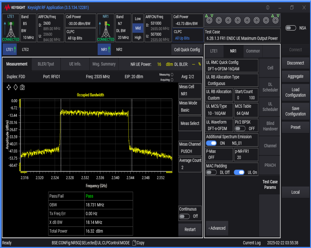
n7 SCS=15kHz DFT_QPSK BW=10MHz Channel=507000 RB=50@0
