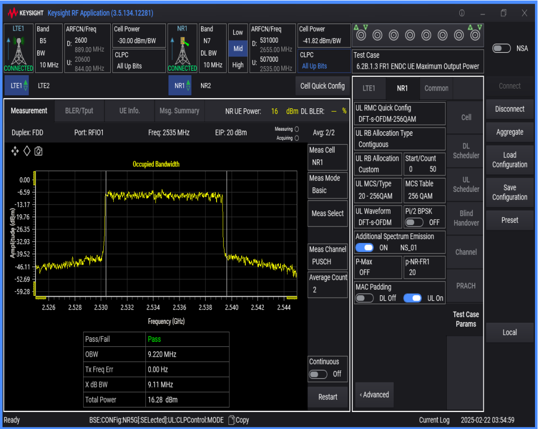
n7 SCS=15kHz DFT_QAM256 BW=20MHz Channel=507000 RB=100@0
