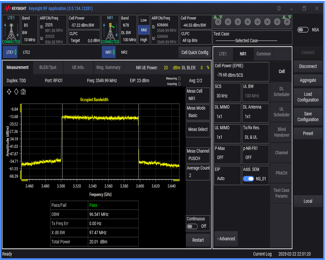
n78 SCS=30kHz DFT_QAM64 BW=20MHz Channel=636666 RB=50@0
