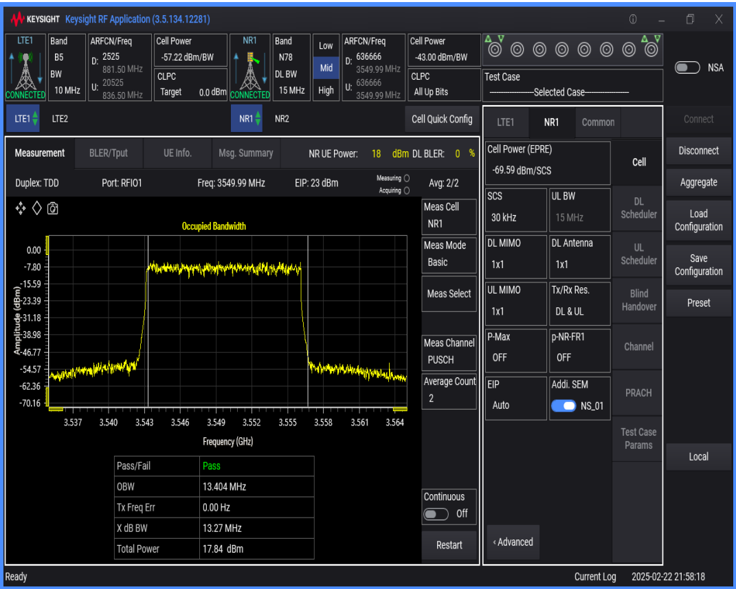
n78 SCS=30kHz DFT_QAM256 BW=20MHz Channel=636666 RB=50@0
