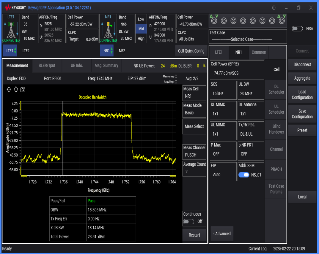
n66 SCS=15kHz DFT_BPSK BW=5MHz Channel=349000 RB=25@0
