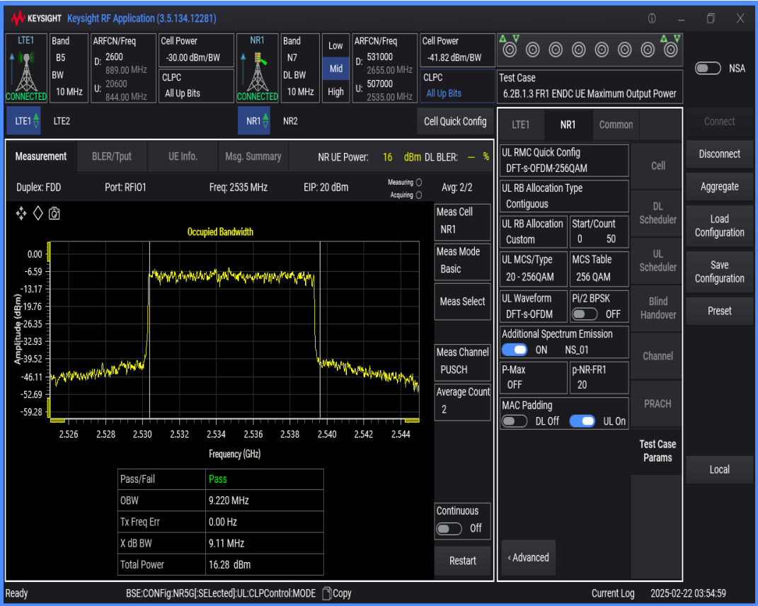
n7 SCS=15kHz DFT_QAM256 BW=20MHz Channel=507000 RB=100@0
