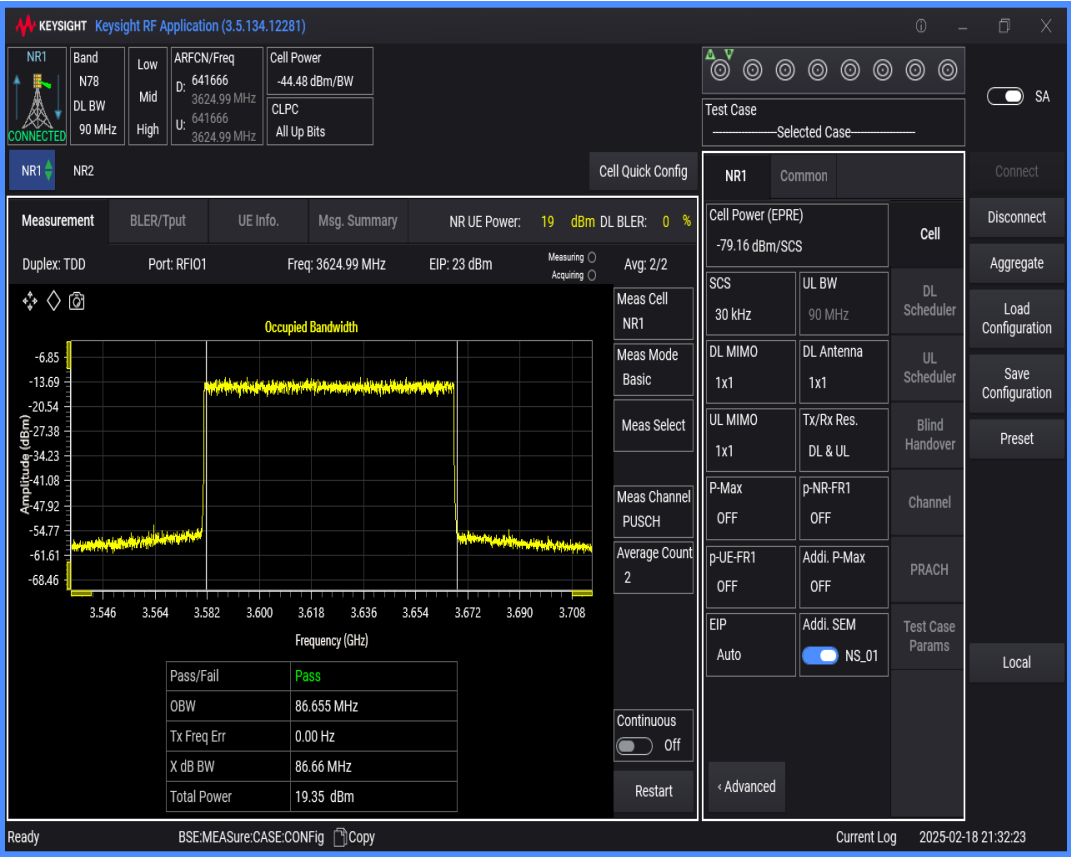
n78(3550-3700) SCS=30kHz DFT_QAM64 BW=20MHz Channel=641666 RB=50@0
