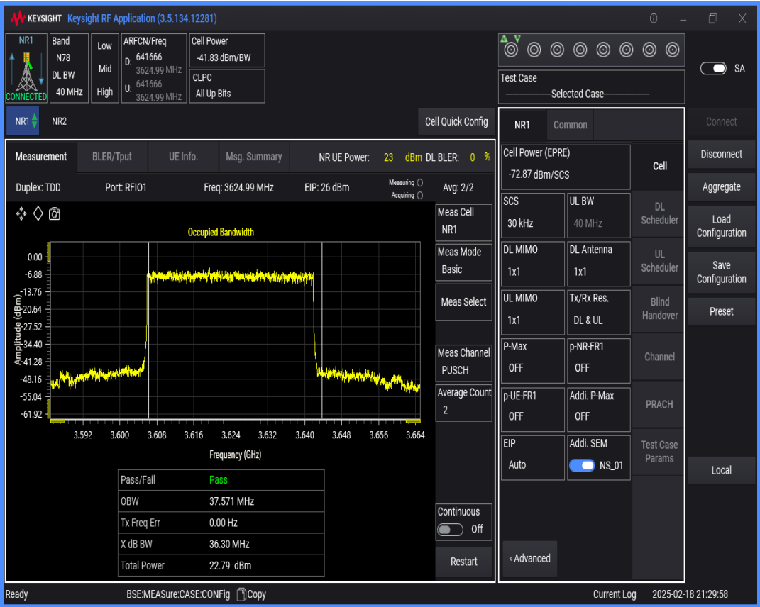
n78(3550-3700) SCS=30kHz DFT_QPSK BW=20MHz Channel=641666 RB=50@0
