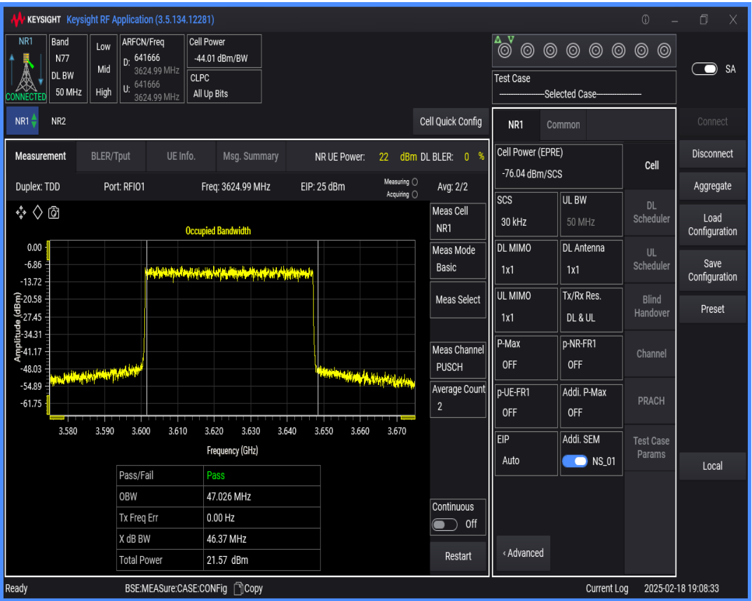
n77(3550-3700) SCS=30kHz DFT_QAM64 BW=20MHz Channel=641666 RB=50@0
