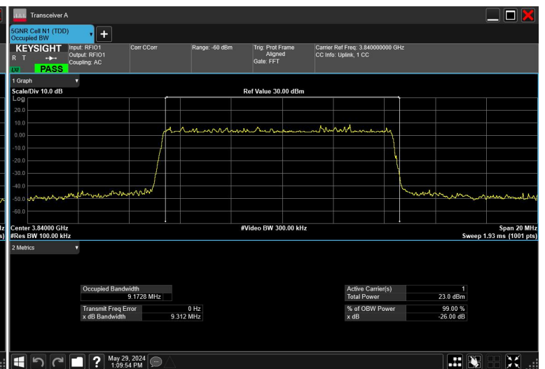
10MHz_15kHz_3840MHz_DFT-s-OFDM \pi/2 BPSK_RB50@0
