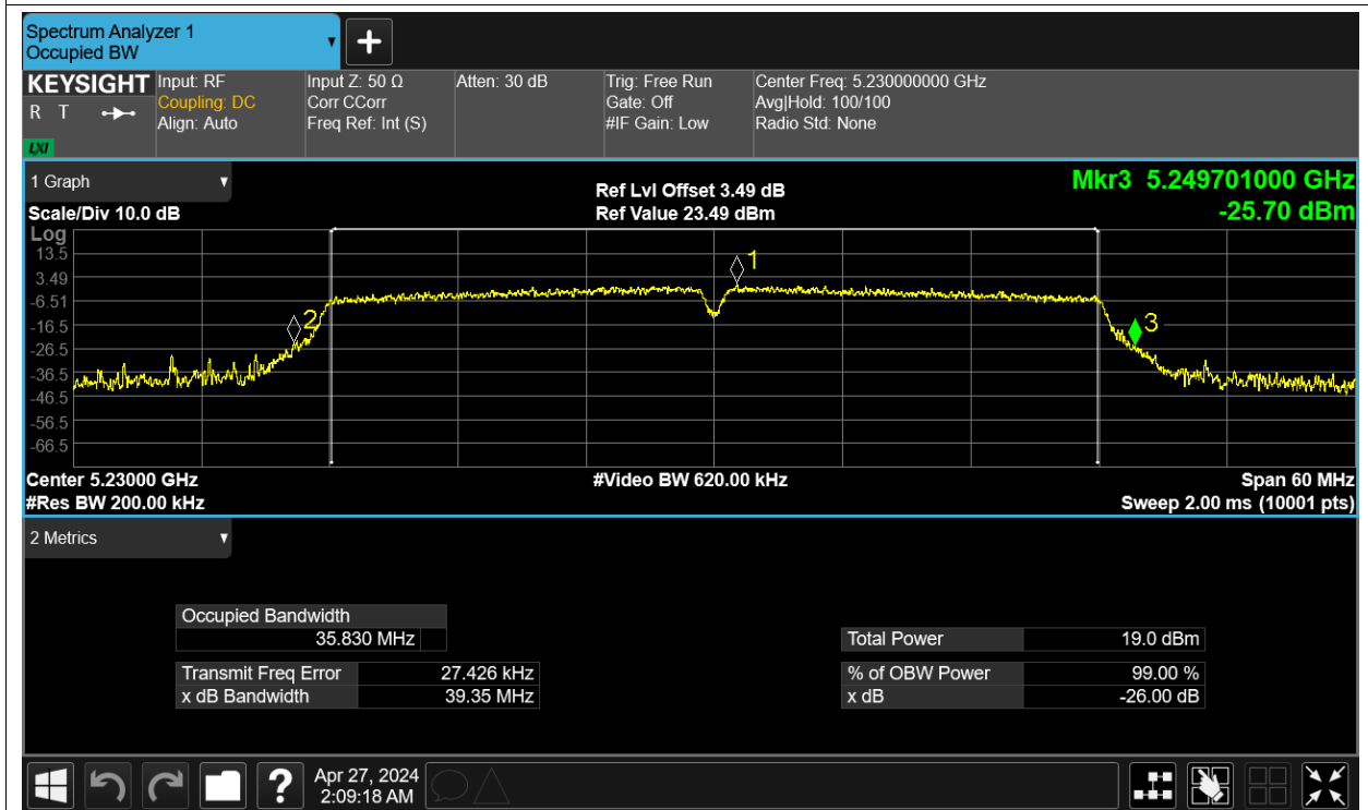
-26dB Bandwidth NVNT ac80 5210MHz Ant14
