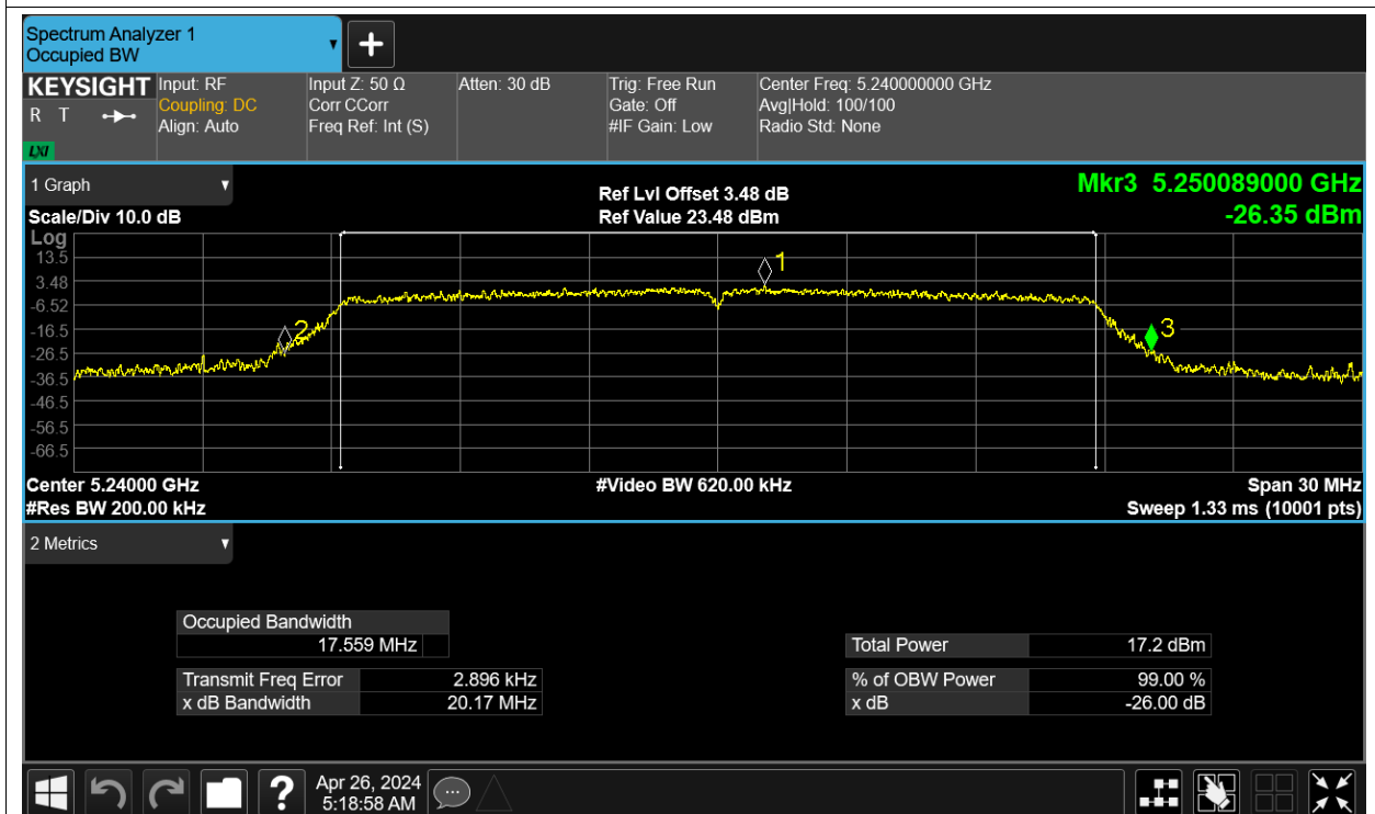
-26dB Bandwidth NVNT n40 5190MHz Ant14
