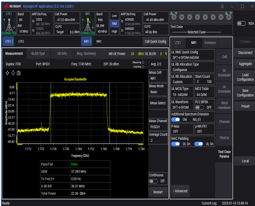
n66 SCS=30kHz DFT_QPSK BW=10MHz Channel=349000 RB=24@0
