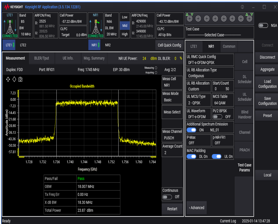
n66 SCS=30kHz DFT_QPSK BW=40MHz Channel=349000 RB=100@0
