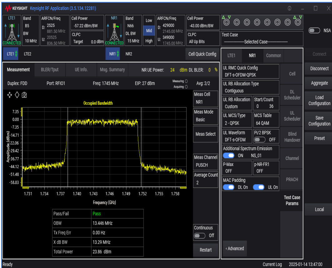
n66 SCS=30kHz DFT_QPSK BW=20MHz Channel=349000 RB=50@0
