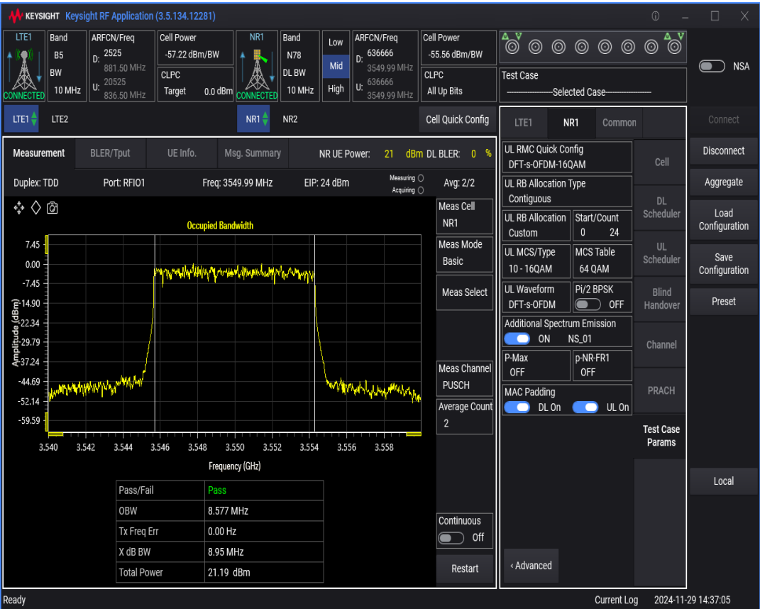
n78 SCS=30kHz DFT_QAM16 BW=20MHz Channel=636666 RB=50@0
