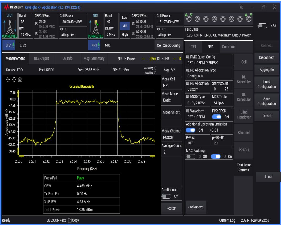
n7 SCS=15kHz DFT_BPSK BW=10MHz Channel=507000 RB=50@0
