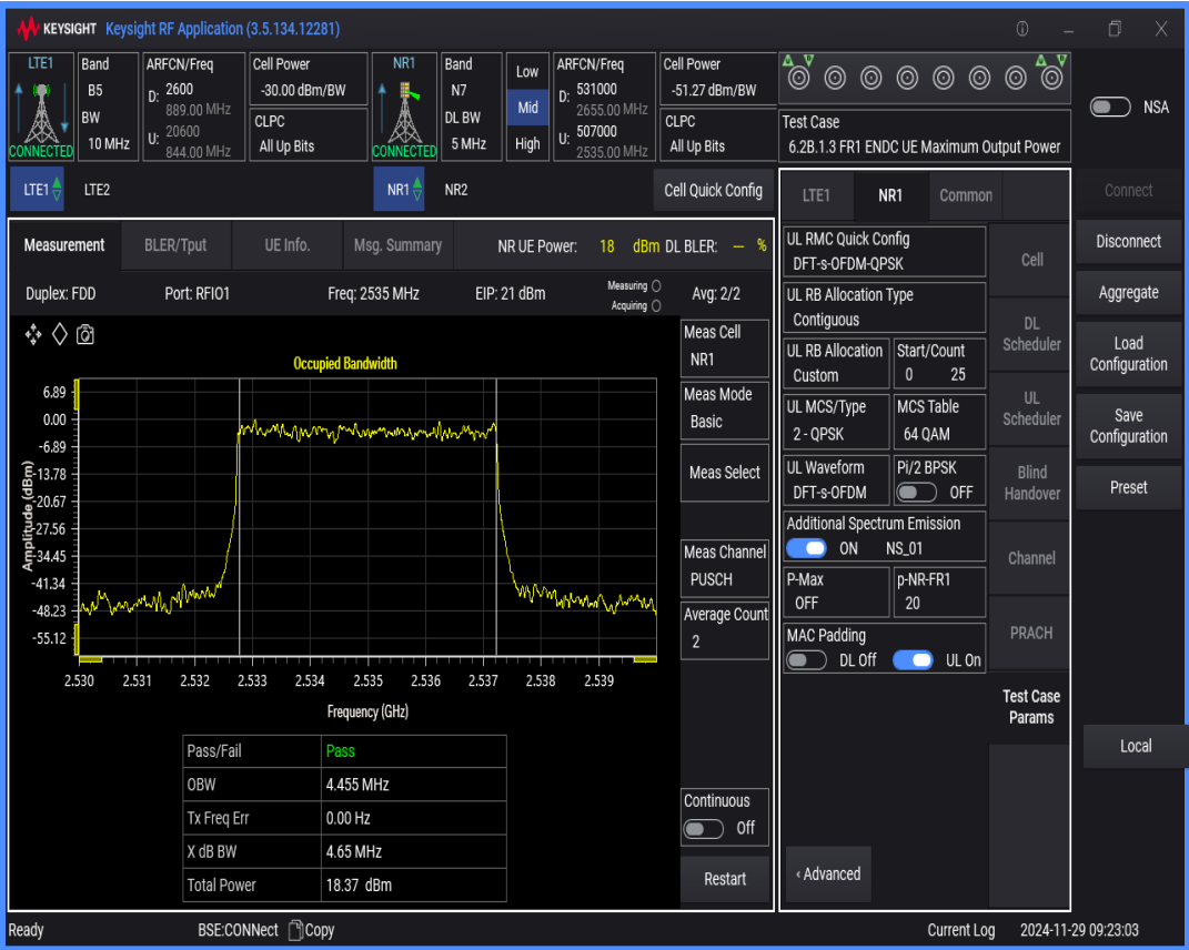
n7 SCS=15kHz DFT_QPSK BW=15MHz Channel=507000 RB=75@0
