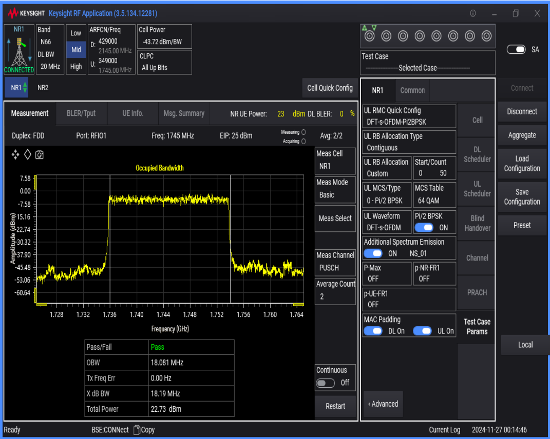
n66 SCS=30kHz DFT_BPSK BW=10MHz Channel=349000 RB=24@0
