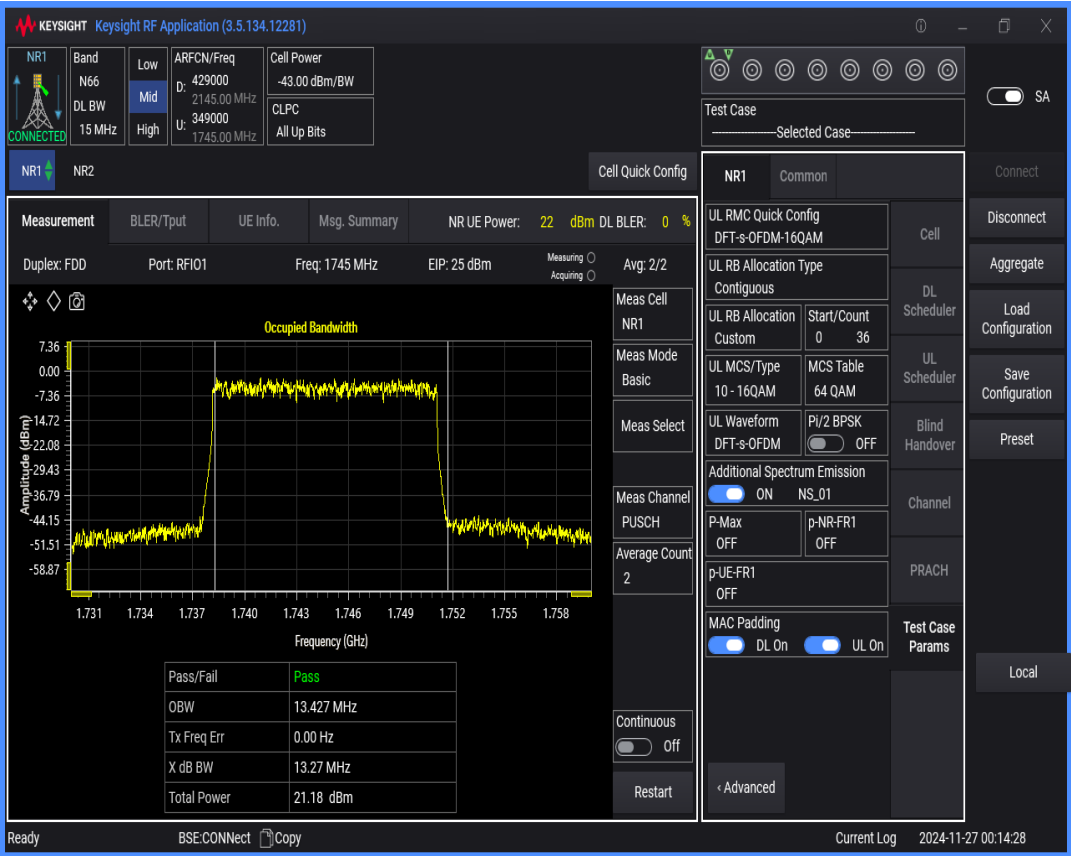
n66 SCS=30kHz DFT_QAM16 BW=20MHz Channel=349000 RB=50@0
