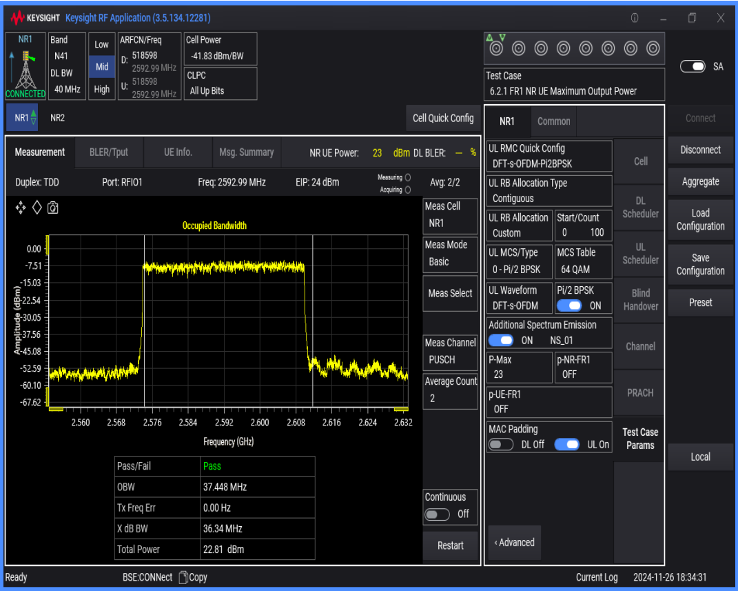
n41 SCS=30kHz DFT_BPSK BW=20MHz Channel=518598 RB=50@0
