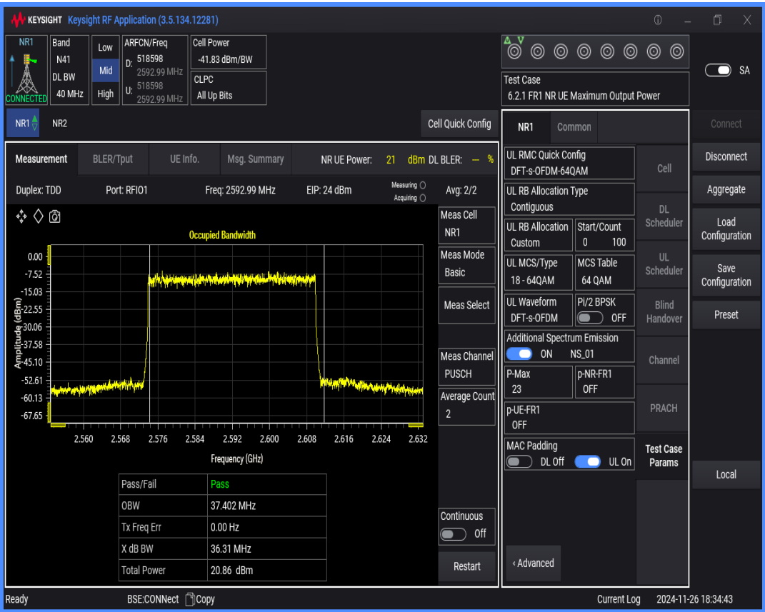
n41 SCS=30kHz DFT_QAM64 BW=20MHz Channel=518598 RB=50@0
