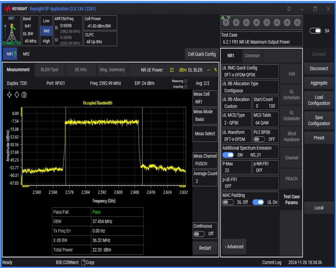
n41 SCS=30kHz DFT_QPSK BW=50MHz Channel=518598 RB=128@0
