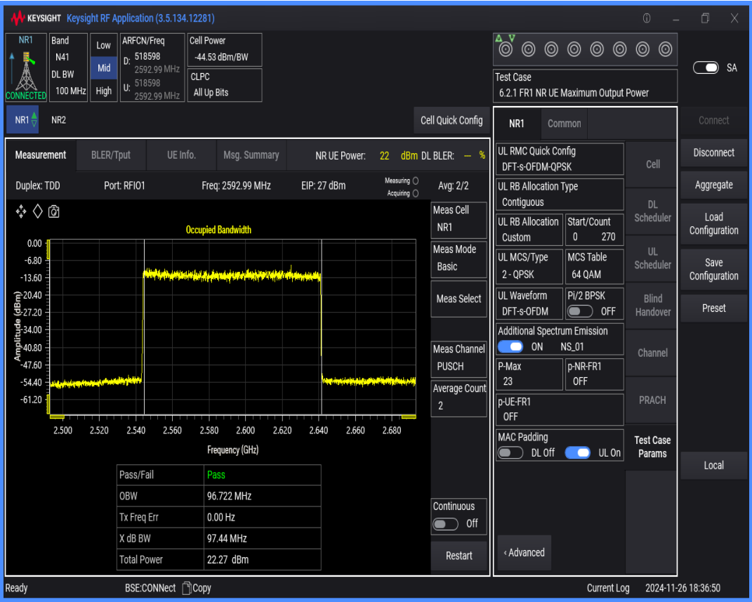
n41 SCS=30kHz DFT_QPSK BW=20MHz Channel=518598 RB=50@0
