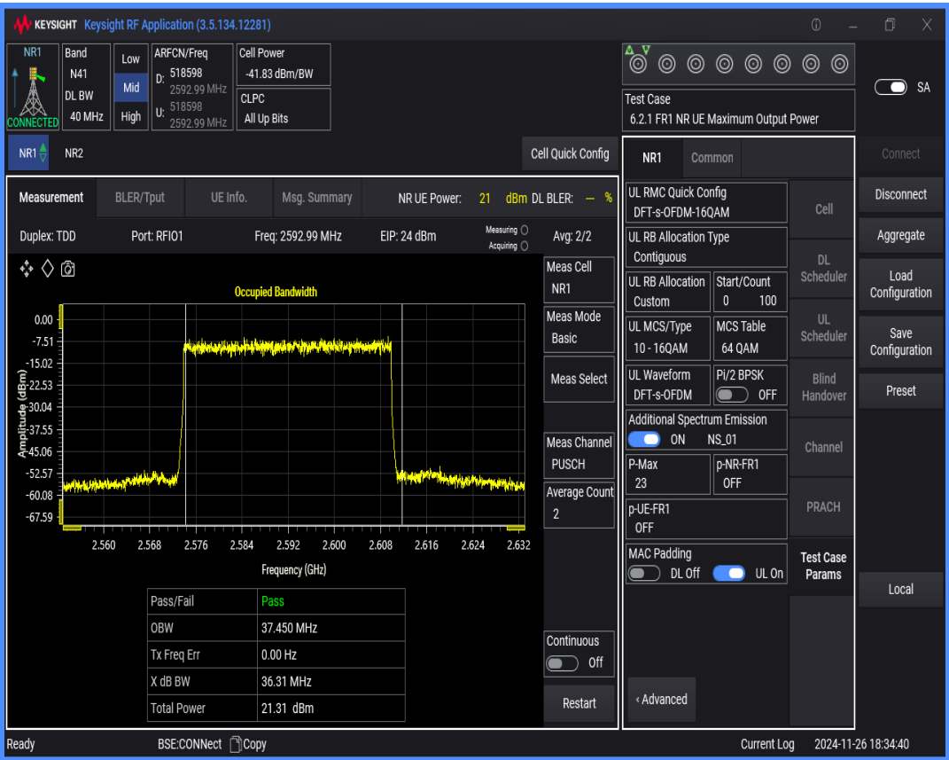
n41 SCS=30kHz DFT_QAM16 BW=20MHz Channel=518598 RB=50@0
