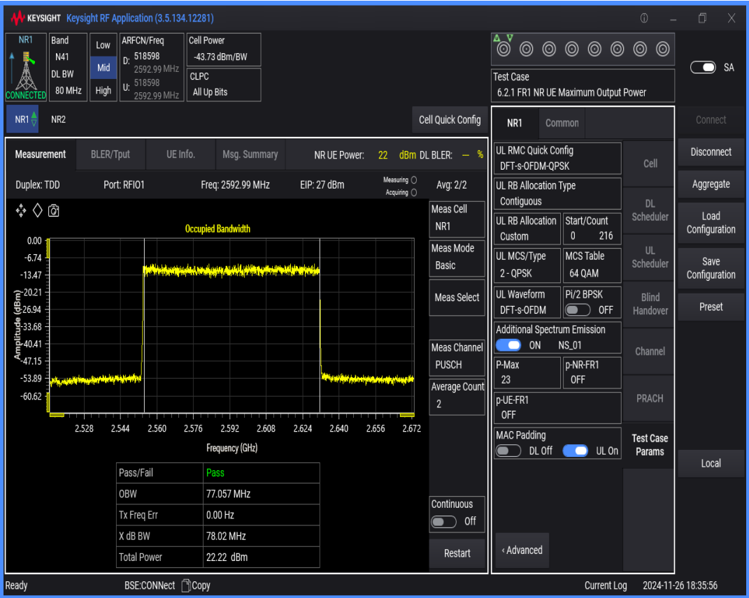
n41 SCS=30kHz DFT_QPSK BW=90MHz Channel=518598 RB=240@0
