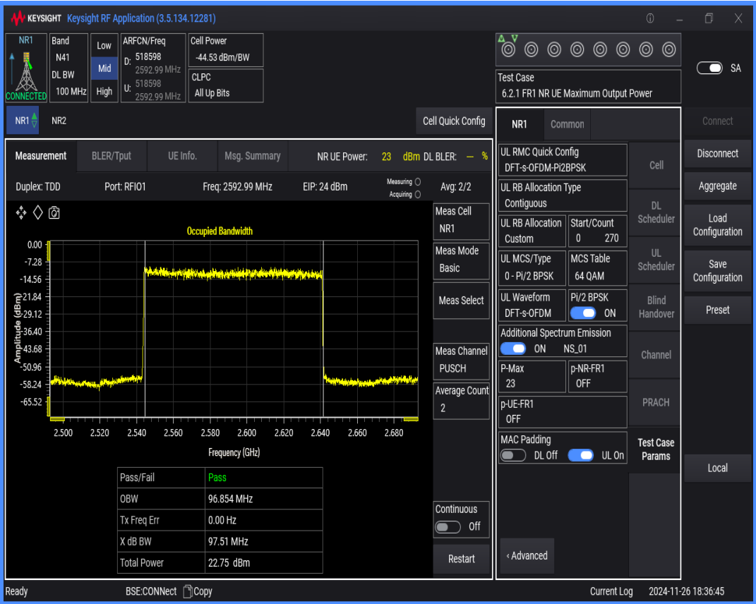
n41 SCS=30kHz DFT_BPSK BW=40MHz Channel=518598 RB=100@0
