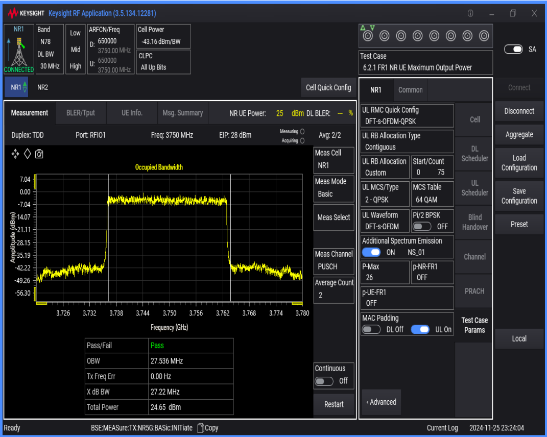
n78(3700-3800) SCS=30kHz DFT_QPSK BW=20MHz Channel=650000 RB=50@0
