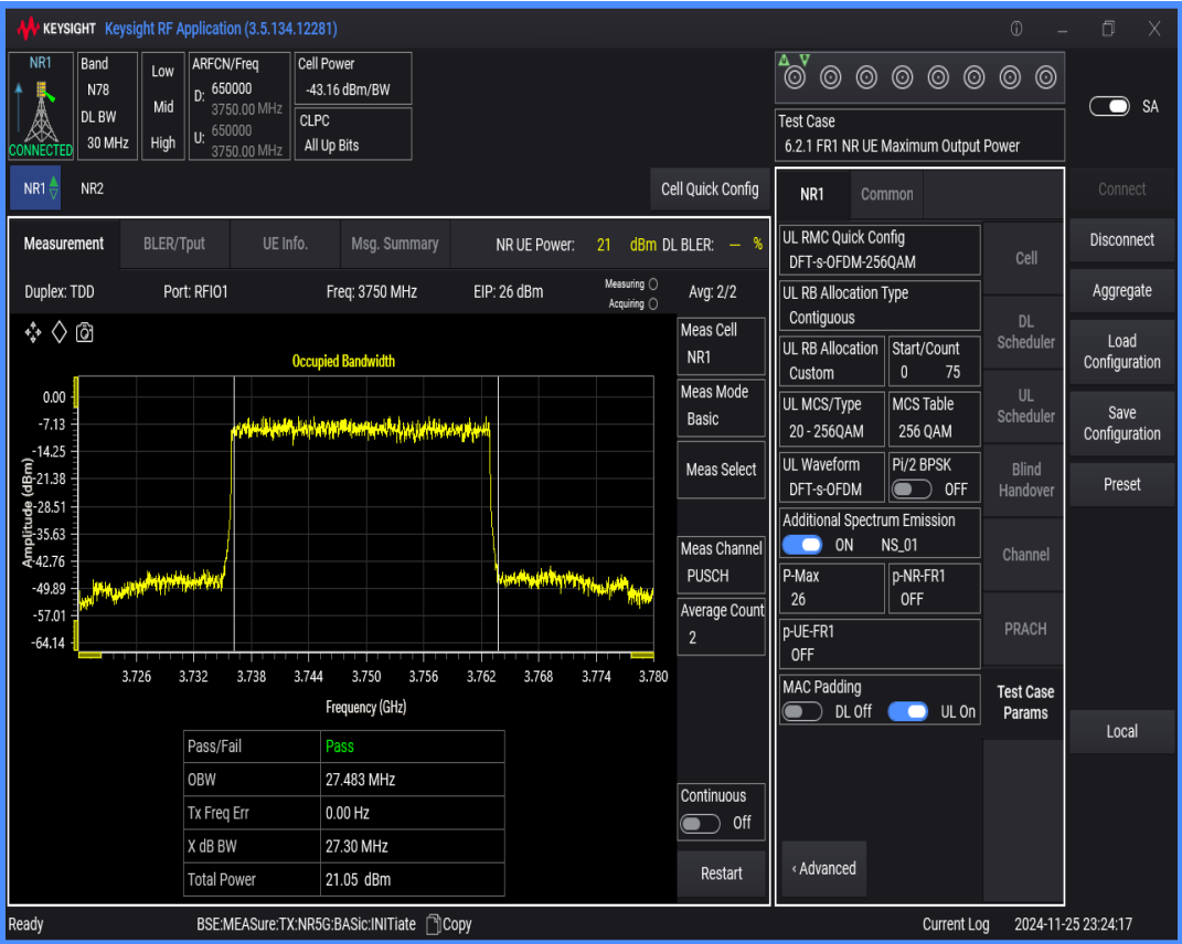
n78(3700-3800) SCS=30kHz DFT_QAM256 BW=20MHz Channel=650000 RB=50@0
