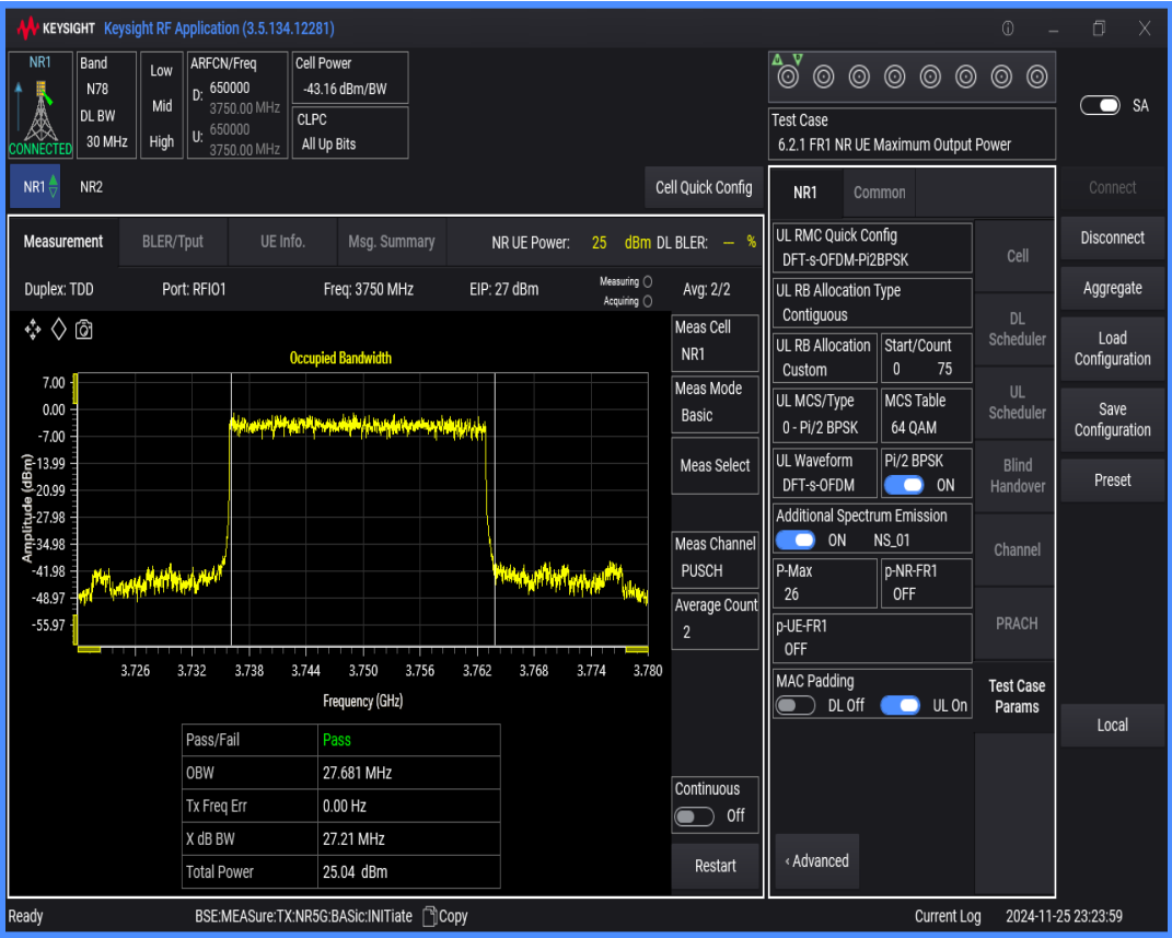
n78(3700-3800) SCS=30kHz DFT_BPSK BW=20MHz Channel=650000 RB=50@0
