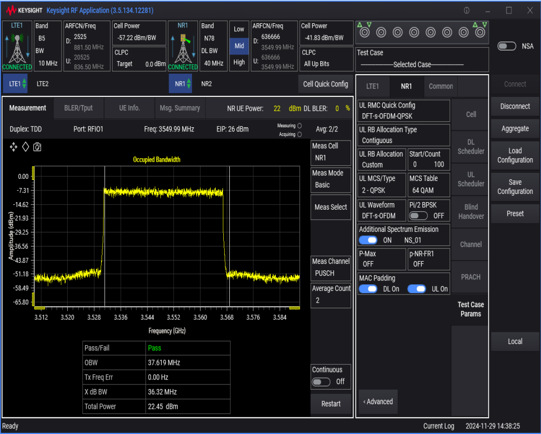
n78 SCS=30kHz DFT_QPSK BW=20MHz Channel=636666 RB=50@0
