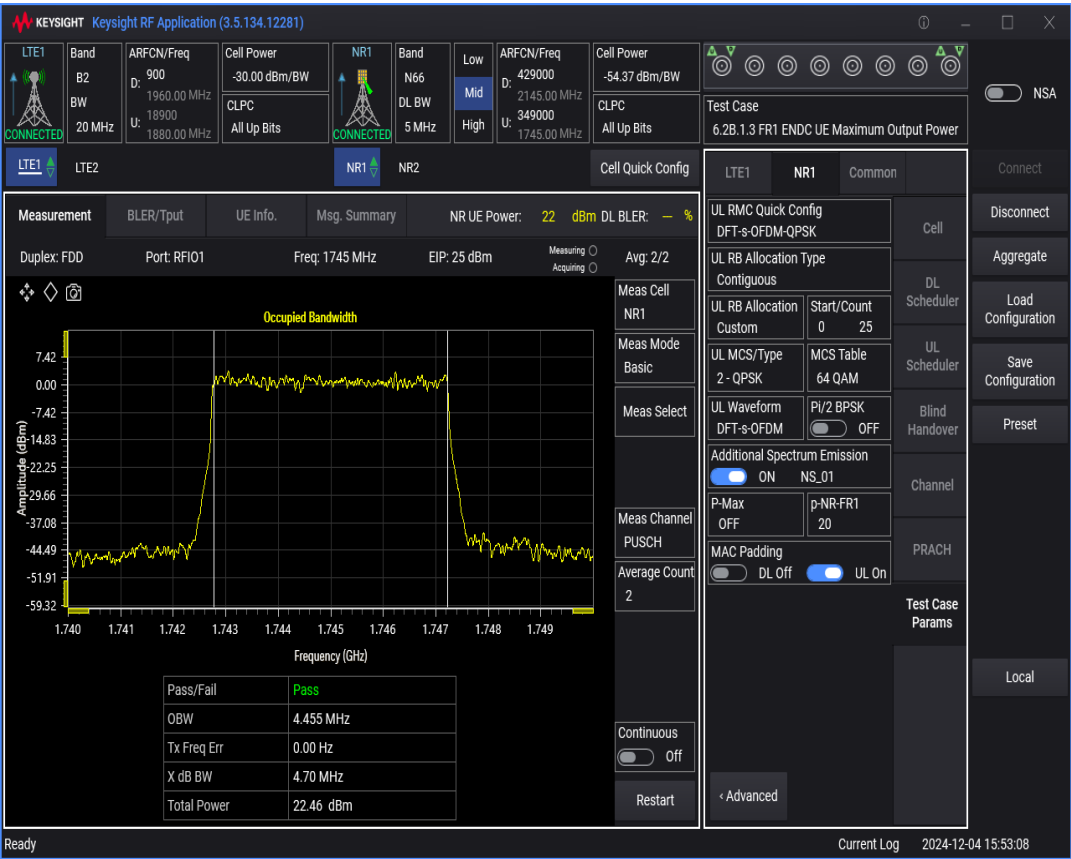
n66 SCS=15kHz DFT_QPSK BW=20MHz Channel=349000 RB=100@0
