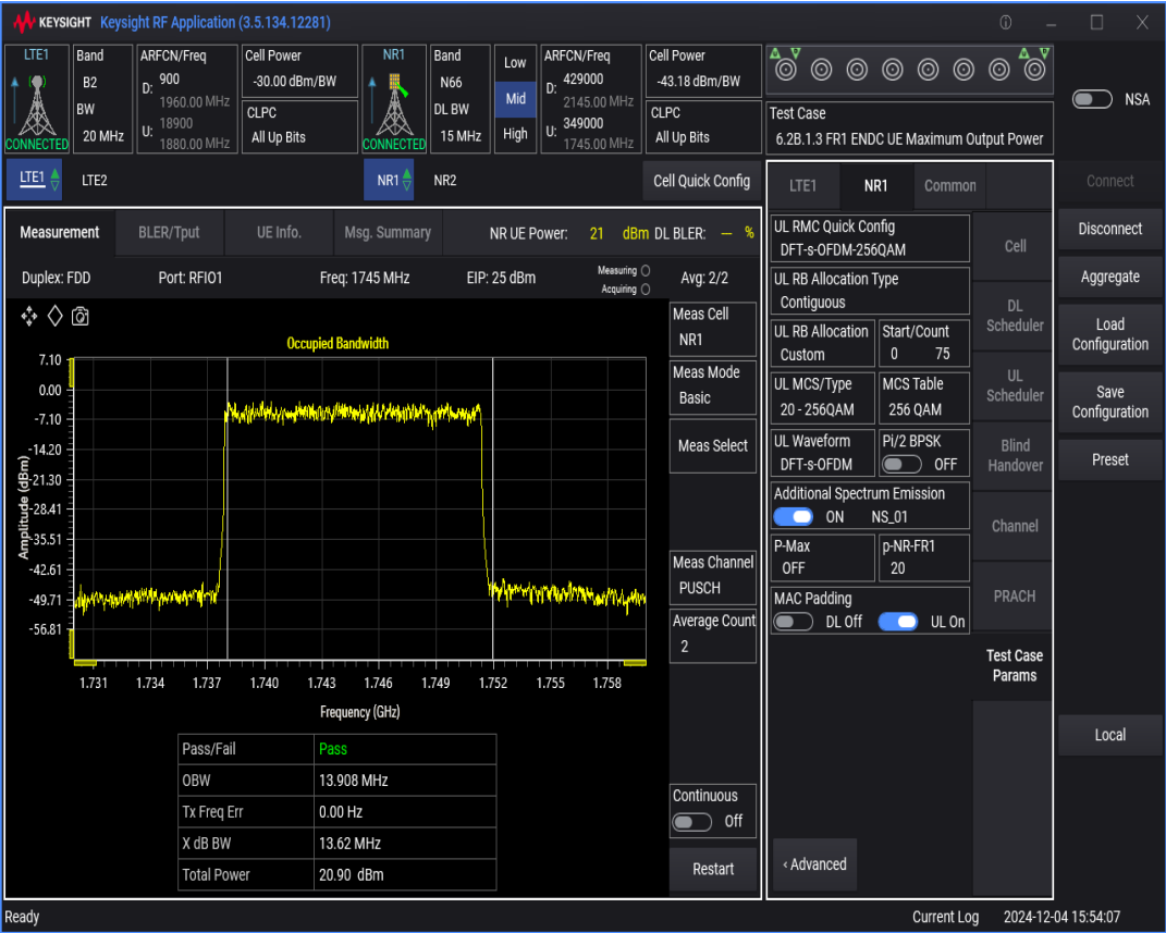
n66 SCS=15kHz DFT_QAM256 BW=10MHz Channel=349000 RB=50@0
