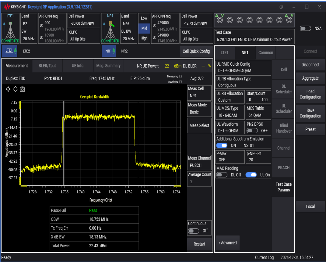
n66 SCS=15kHz DFT_QPSK BW=40MHz Channel=349000 RB=216@0
