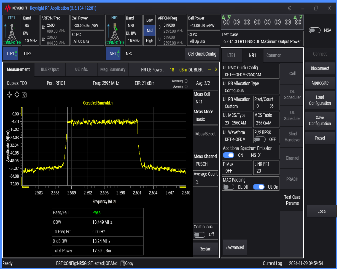
n38 SCS=30kHz DFT_QAM256 BW=10MHz Channel=519000 RB=24@0
