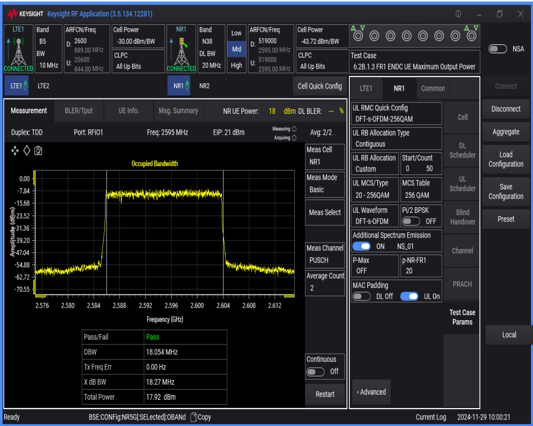
n38 SCS=30kHz DFT_QAM16 BW=20MHz Channel=519000 RB=50@0
