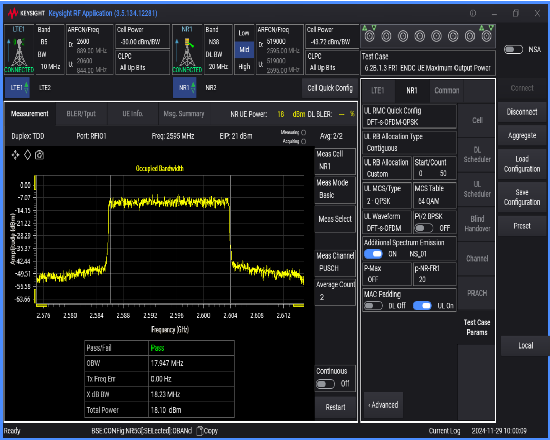
n38 SCS=30kHz DFT_QPSK BW=10MHz Channel=519000 RB=24@0
