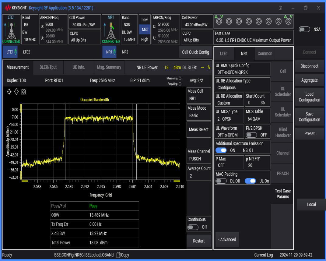
n38 SCS=30kHz DFT_QPSK BW=20MHz Channel=519000 RB=50@0
