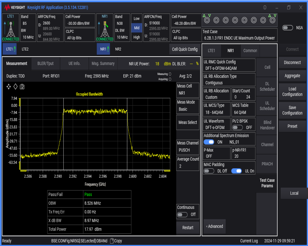
n38 SCS=30kHz DFT_QAM256 BW=20MHz Channel=519000 RB=50@0
