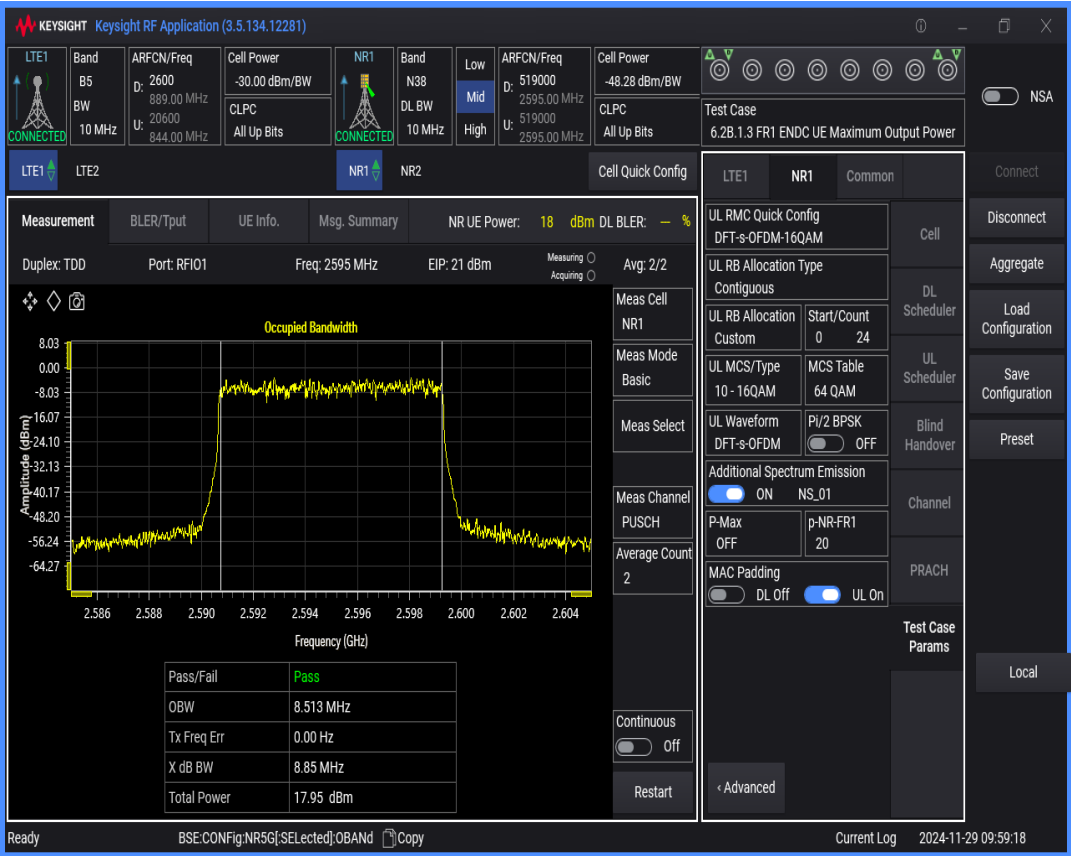
n38 SCS=30kHz DFT_QPSK BW=15MHz Channel=519000 RB=36@0
