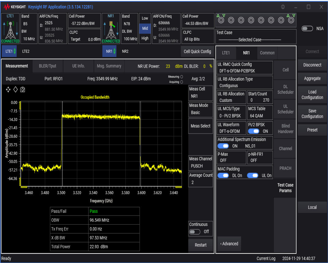
n78 SCS=30kHz DFT_BPSK BW=20MHz Channel=636666 RB=50@0
