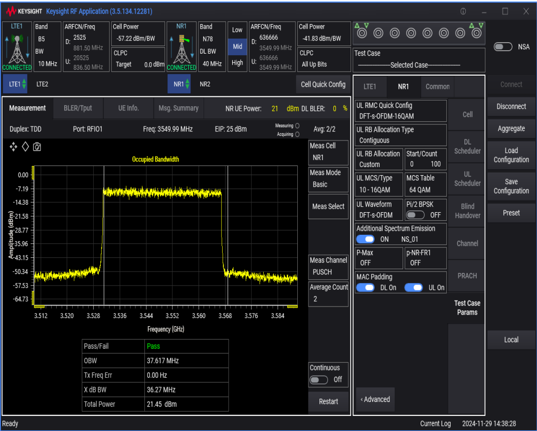
n78 SCS=30kHz DFT_QAM16 BW=20MHz Channel=636666 RB=50@0
