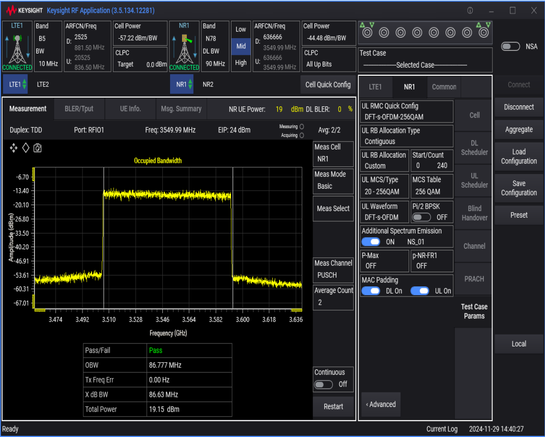
n78 SCS=30kHz DFT_QAM256 BW=20MHz Channel=636666 RB=50@0
