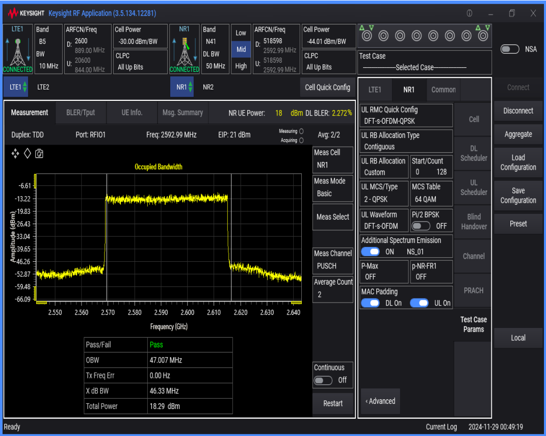
n41 SCS=30kHz DFT_QPSK BW=90MHz Channel=518598 RB=240@0
