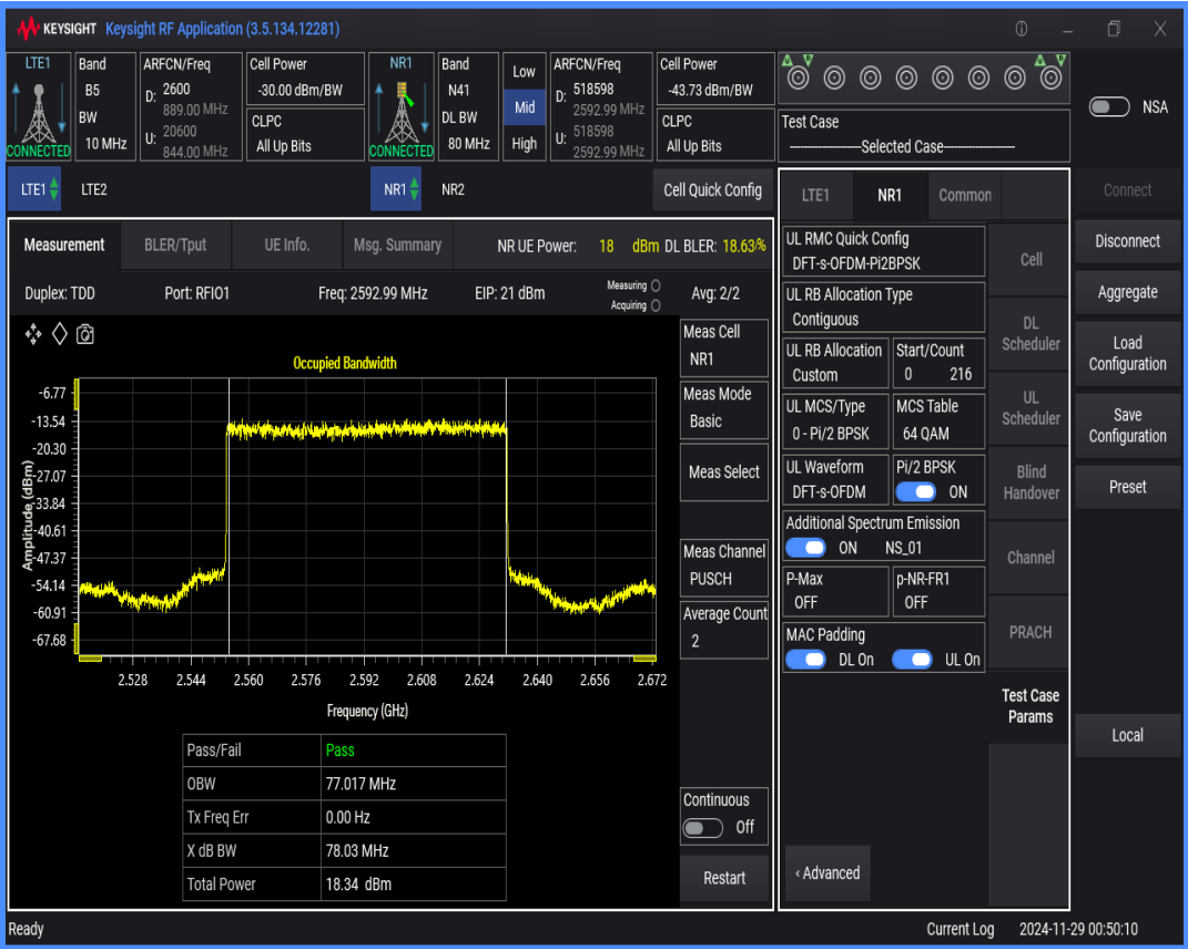
n41 SCS=30kHz DFT_QAM16 BW=20MHz Channel=518598 RB=50@0
