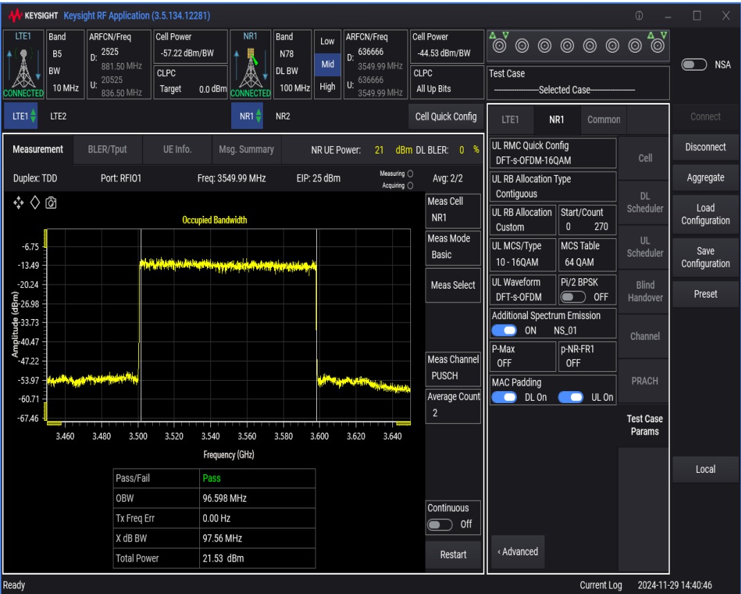
n78 SCS=30kHz DFT_QAM16 BW=20MHz Channel=636666 RB=50@0
