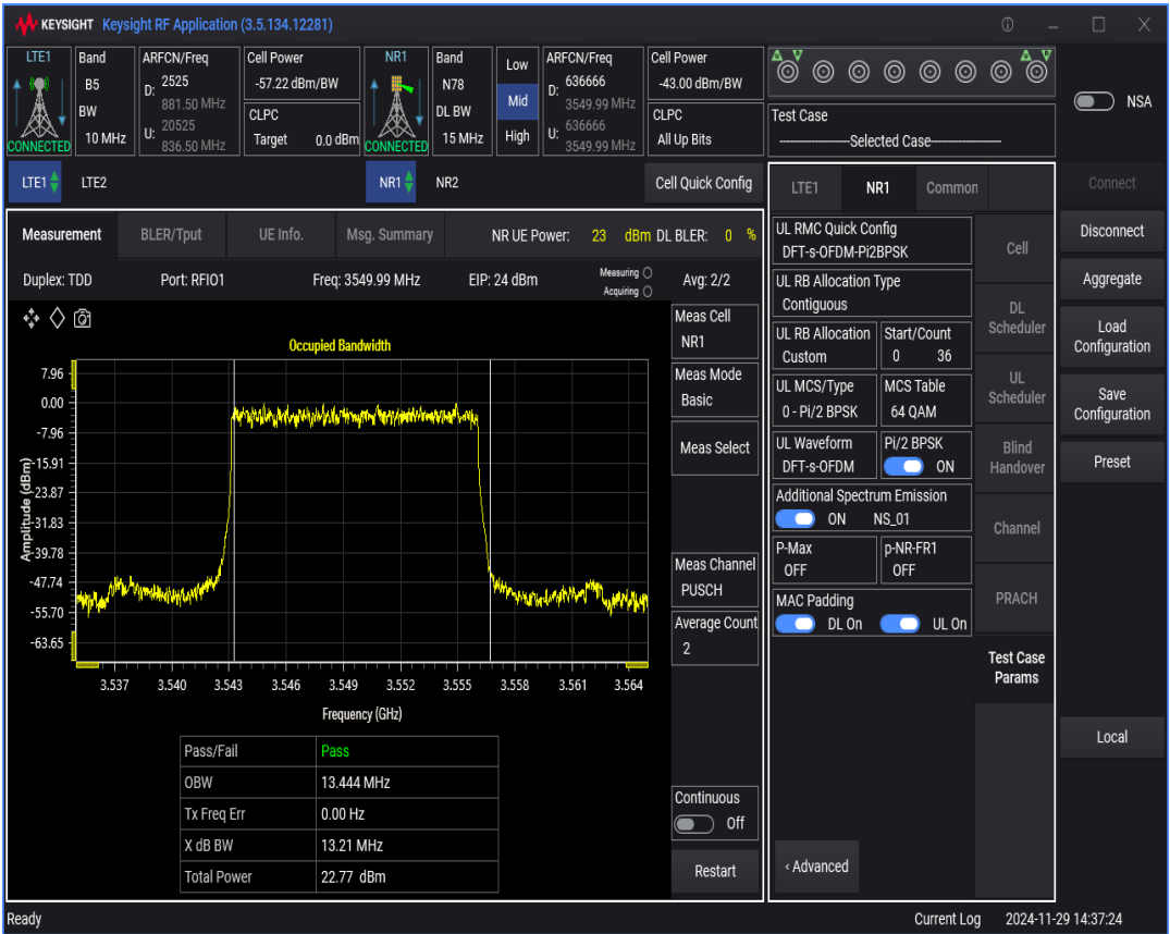
n78 SCS=30kHz DFT_BPSK BW=20MHz Channel=636666 RB=50@0
