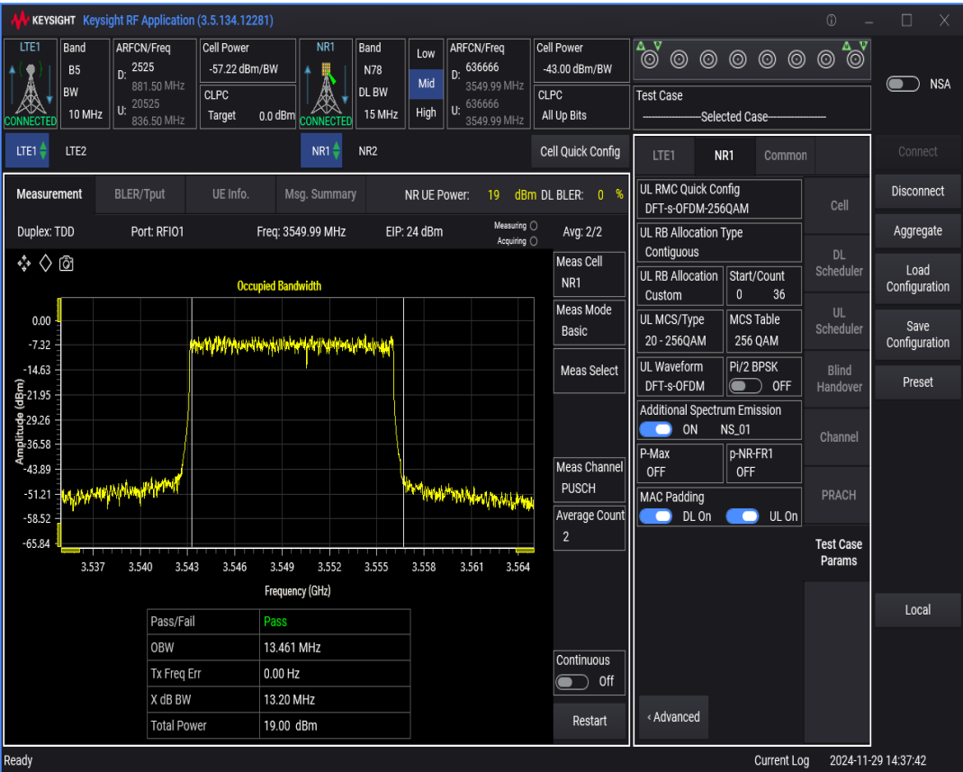
n78 SCS=30kHz DFT_QAM256 BW=20MHz Channel=636666 RB=50@0
