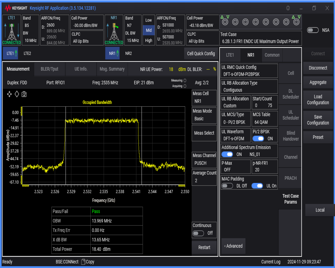
n7 SCS=15kHz DFT_BPSK BW=10MHz Channel=507000 RB=50@0
