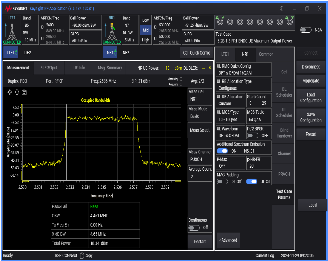
n7 SCS=15kHz DFT_QAM16 BW=10MHz Channel=507000 RB=50@0
