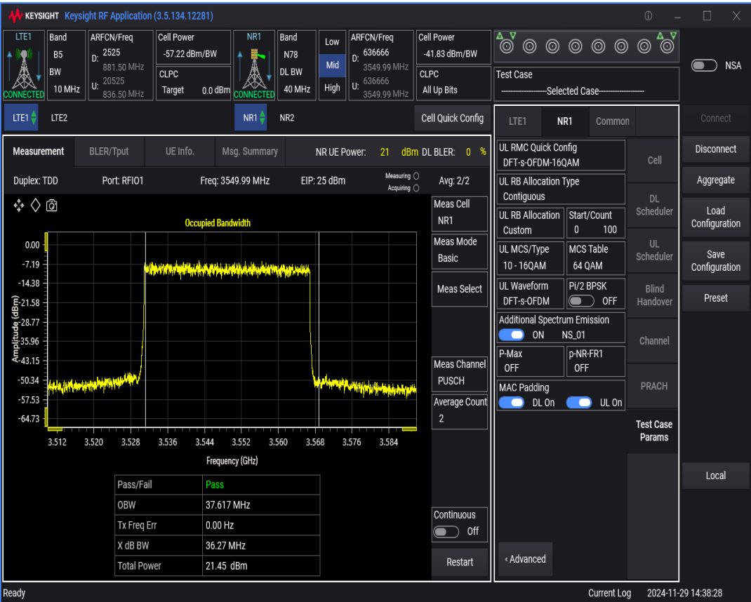
n78 SCS=30kHz DFT_QAM16 BW=20MHz Channel=636666 RB=50@0
