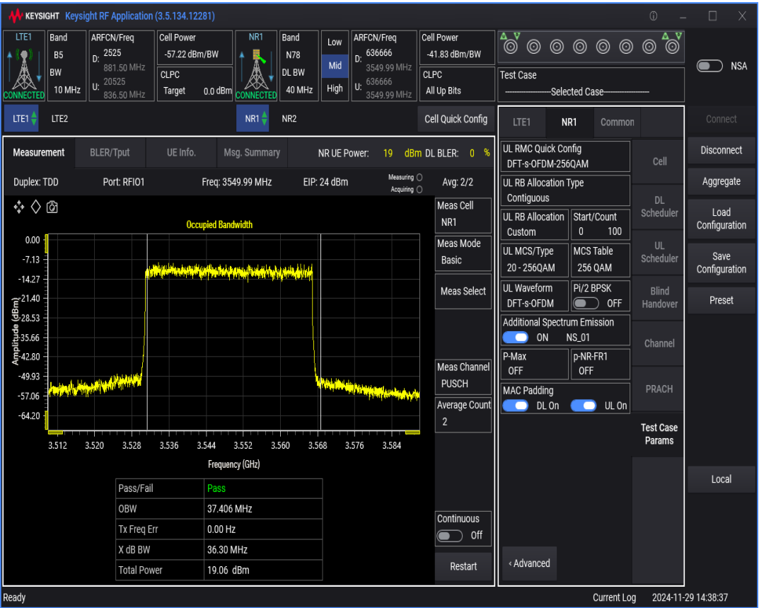
n78 SCS=30kHz DFT_QAM256 BW=20MHz Channel=636666 RB=50@0
